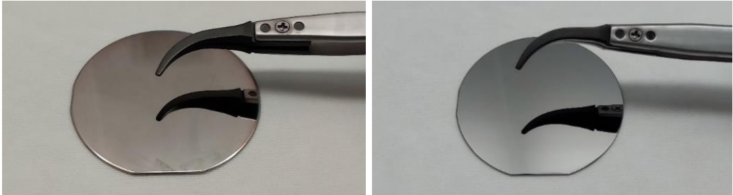
Görsel 4.2. Düzensiz desenleme işleminden sonra yüzeyi Ag kaplı 2 inç Si alttaş (solda) ve Ag kaplama temizlendikten sonra düzensiz desenlenmiş alttaş (sağda)
