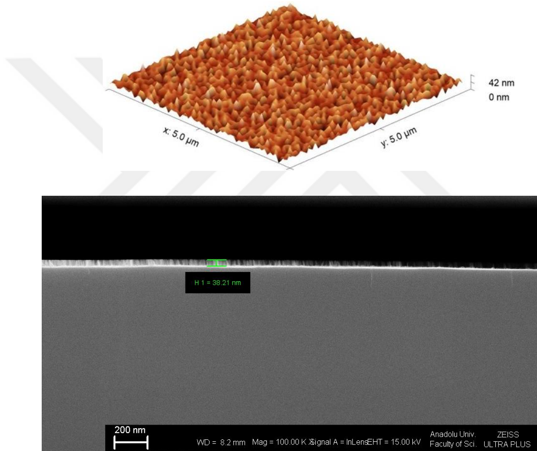
Şekil 4.7. Düzensiz Desenleme işlemi sonrası yüzeyden alınan AFM (üstte) ve yan-kesit SEM (altta) görüntüleri
