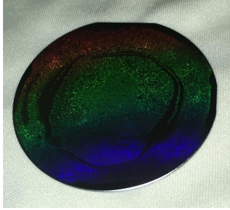
Görsel 4.14. MACE sonrası düzenli desenlenmiş büyütme işlemi için hazır 2 inç Si alttaş görüntüsü
