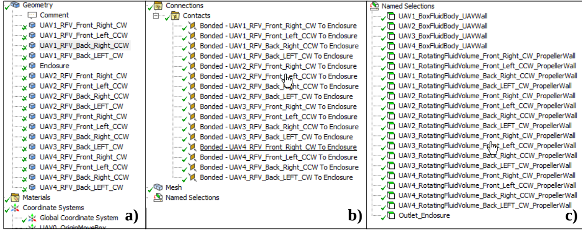
Şekil 3.13. Çözüm Ağı Tanımlamaları; a) Aktarılan Geometriler b) Bağlantılar c) İsimlendirmeler
