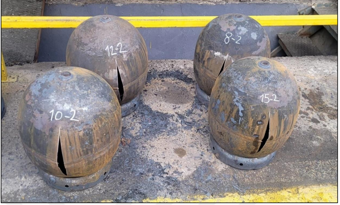
Şekil 4.11. Farklı bıçak kordon açısında imal edilmiş LPG tüpüne ait patlatma-genleşme deney sonrası görüntüleri
