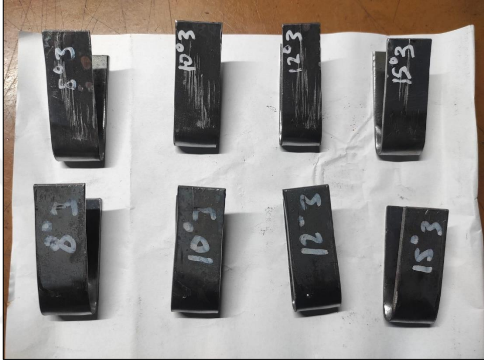
Şekil 4.5. Farklı kordon açılarında imal edilmiş tüplerin eğme deney sonrası görüntüleri
