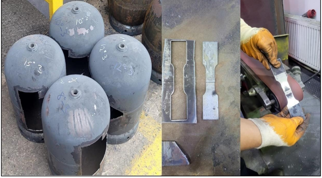
Şekil 3.11. Çekme deney numunelerinin hazırlanması
