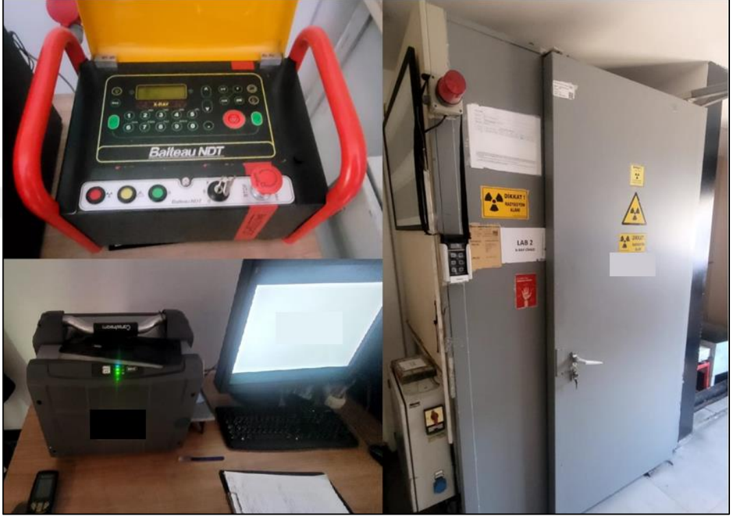
Şekil 3.8. İmalatı yapılan tüplerin X-Ray incelemeleri
