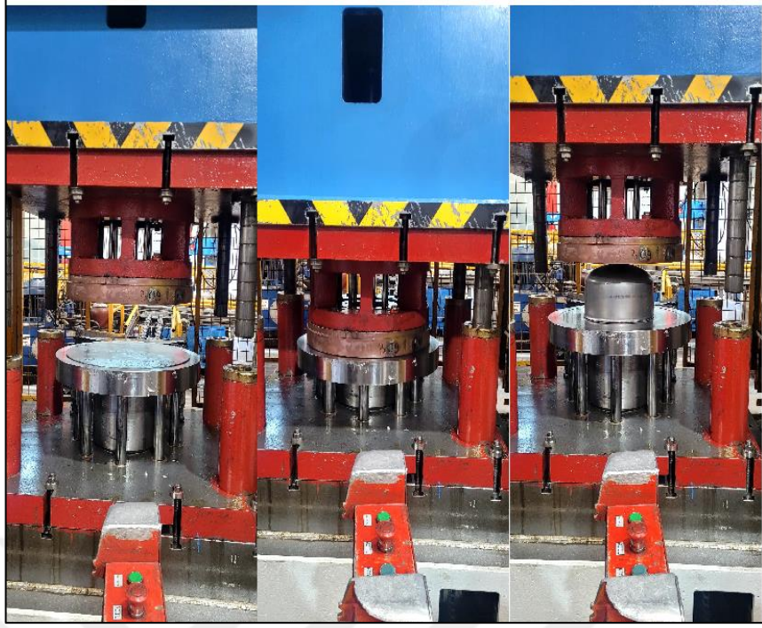
Şekil 3.5. Yeni yapılan tasarıma uygun alt ve üst kovan imalatı
