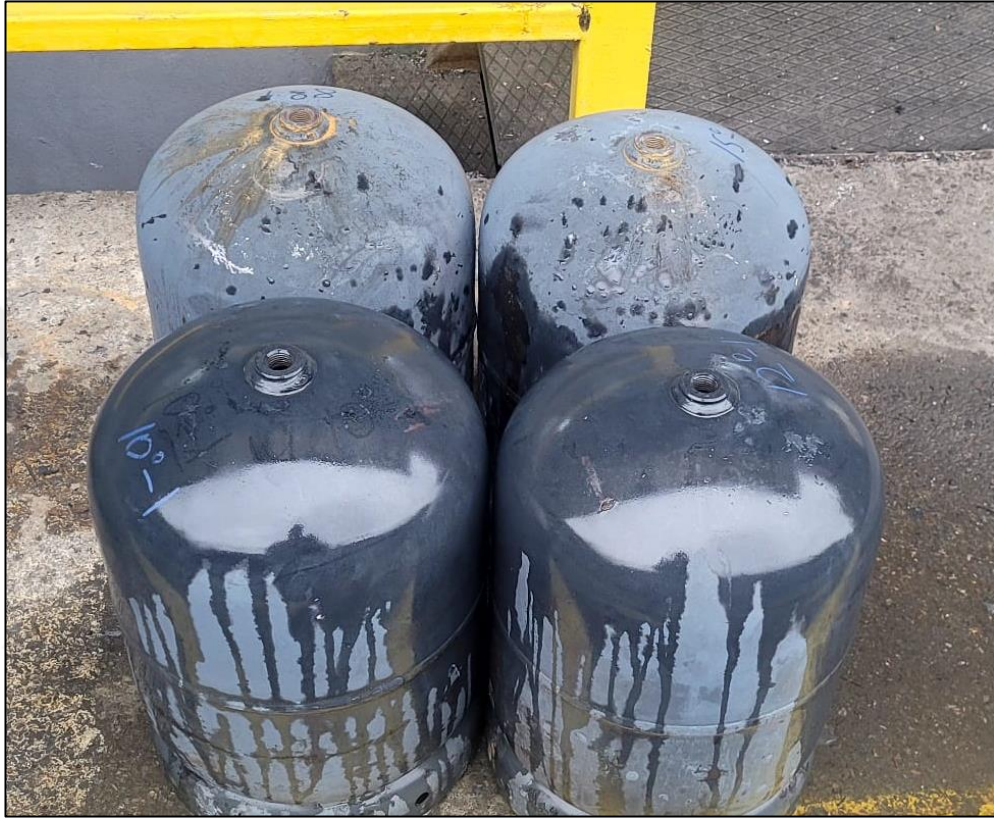
Şekil 4.6. Farklı kordon açılarında imal edilmiş tüplerin basınçla yorulma deney sonrası görüntüleri
