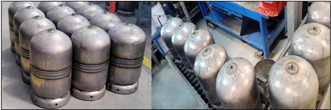
Şekil 3.7. Yeni tasarıma uygun birleştirilen LPG tüpleri
