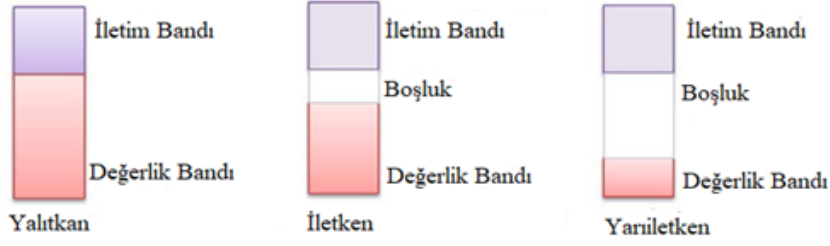
Şekil 2.2. Değerlik bandı, bant aralığı (boşluk) ve iletim bandı: yalıtkan, iletken ve yarı iletken.
