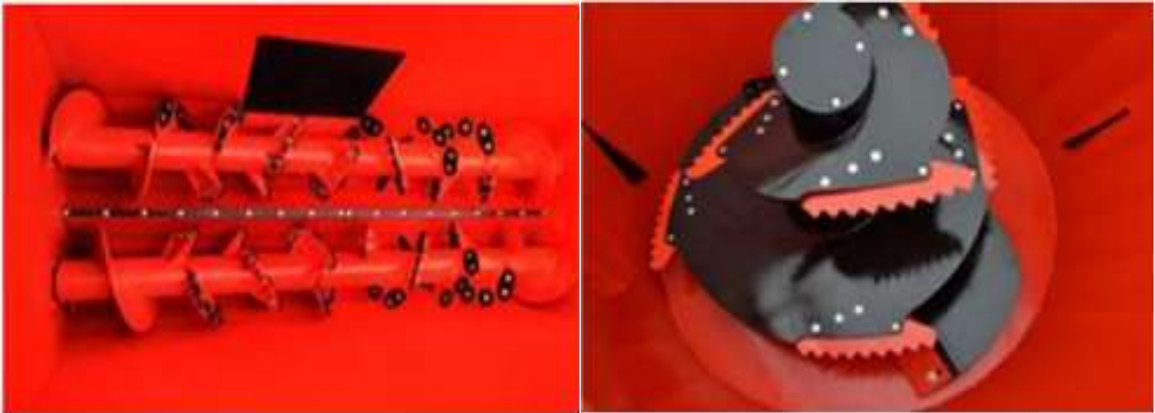
Resim 3.1. Yatay ve düşey helezonlu karıştırıcılar
