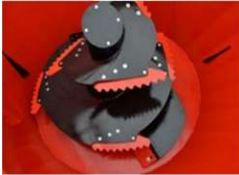
Resim 1.4. Düşey helezonlu yem karma makinesi
