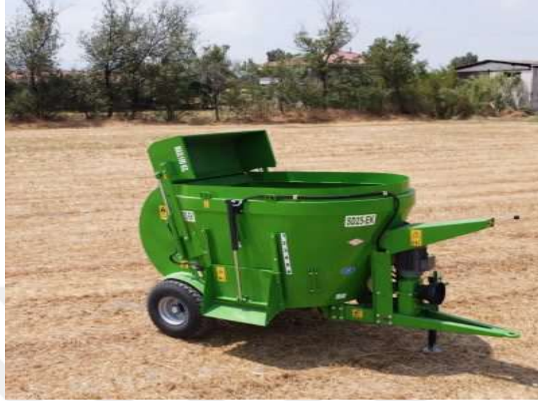
Resim 1.6. Düşey helezonlu yem karma makinesi
