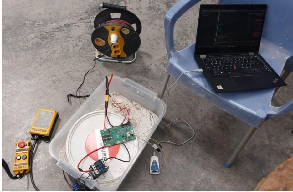
Şekil 4.26 : Batarya kısa devre test düzeneği.
