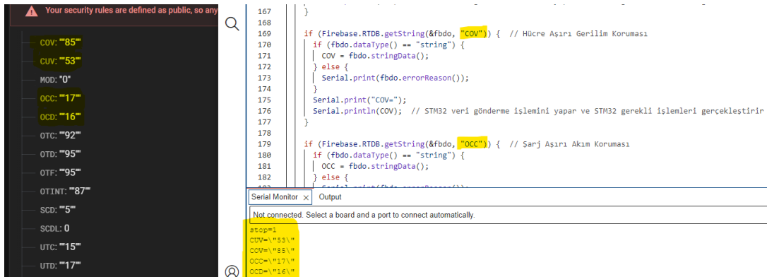
Şekil 4.39 : Koruma Parametrelerinin Firebase üzerinden okunması.
