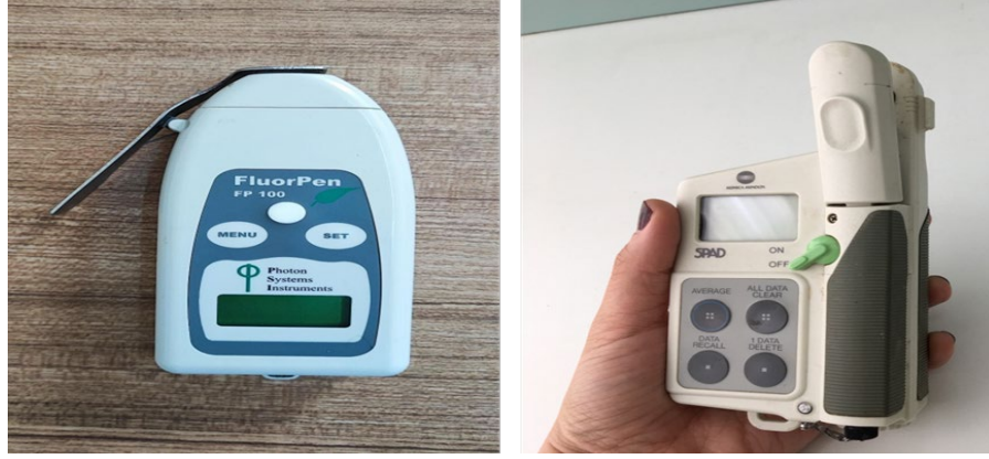
Şekil 3.13. Bitkilerden SPAD, QY ve PAR ölçümleri yapılırken kullanılan cihazlara ait görseller
