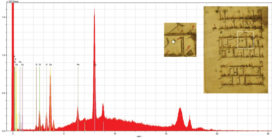
Şekil 5.1.3.10 25a sayfasındaki yeşil harekenin XRF spektrumu
