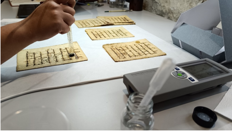
Görsel 5.2.5 D6331 parşömeninde pH ölçümü
