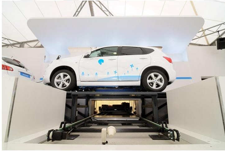
Şekil 3. Tipik bir batarya değişim istasyonu (Wired, 2024)
