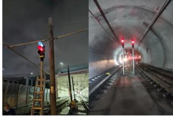
Şekil 3.6. Sol: Kırmızı üstü beyaz (ATP rotası) sağ: kırmızı sinyal (dur)
