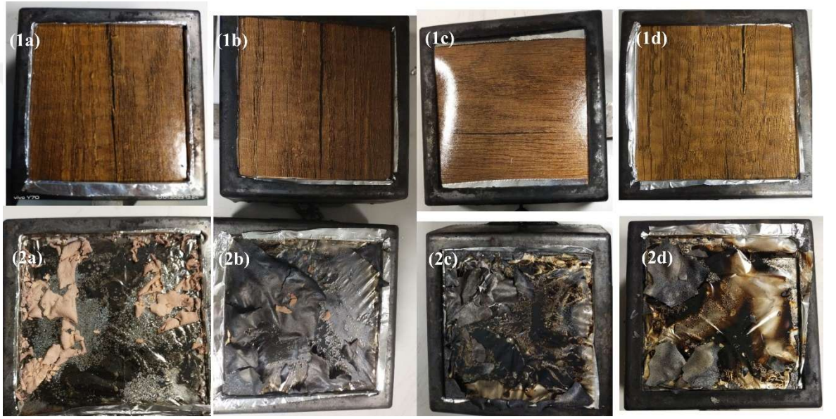
Şekil 5.9: MF ve MF-BG ile emprenye edilmiş kağıtların dijital resimleri; (1a) MF, (1b) MF-BG5, (1c) MF-BG10 ve (1d) MF-BG15 konik kalorimetre öncesi ve konik kalorimetre testinden sonra kalan (2a) MF, (2b) MF-BG5, (2c) MF-BG10 ve (2d) MF-BG15 örnekleri.
