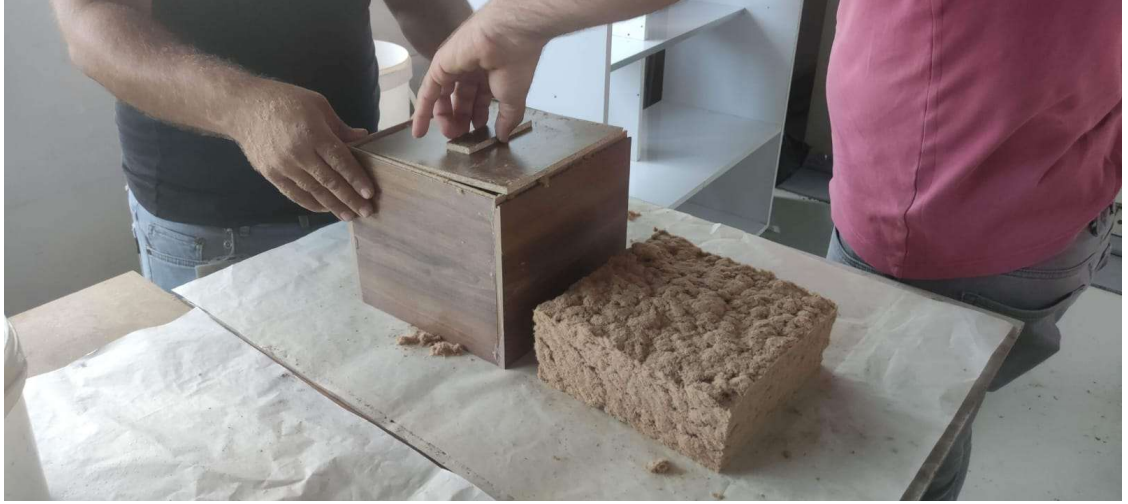
Şekil 4.9: MDF basımı için hazırlanan matların sıkıştırılarak son haline getirilmesi.
