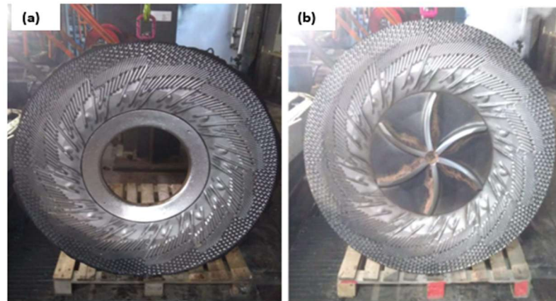
Şekil 2.13: Liflendirme makinası sabit ve hareketli bıçak resimleri (a) Rotor - (b) Stator.
