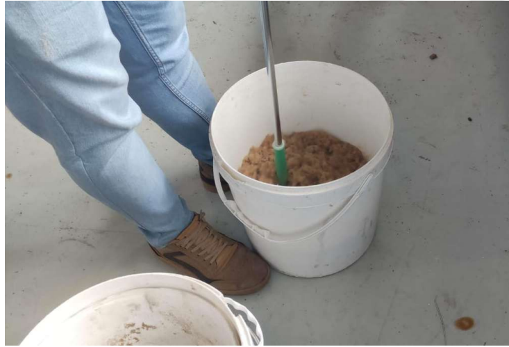
Şekil 4.8: Tutkallanmış liflerin HACP eklendikten sonra karıştırılması.
