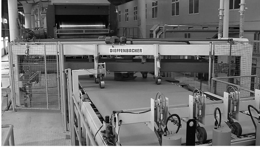
Şekil 2.16: Sürekli sıcak preslemeden sonra ana panelleri kesmek için diyagonal döner testere.
