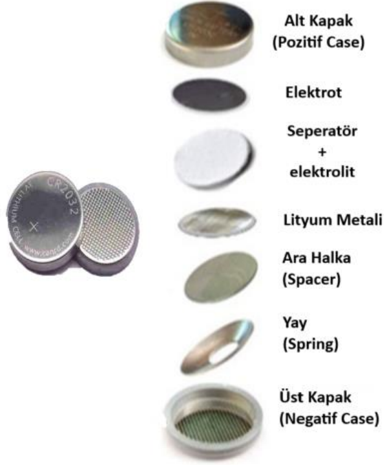
Şekil 3.3: Sırasıyla CR2032 düğme pil parçaları.
