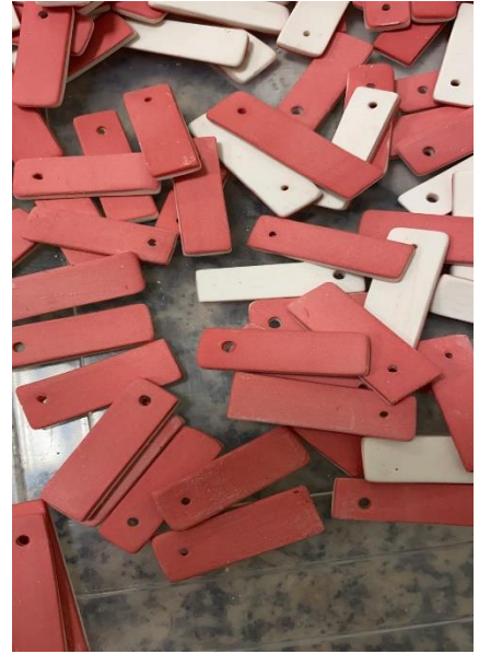
Resim 4.6. 1205 °C’de pişirilmiş olan delikli porselen parçalar
