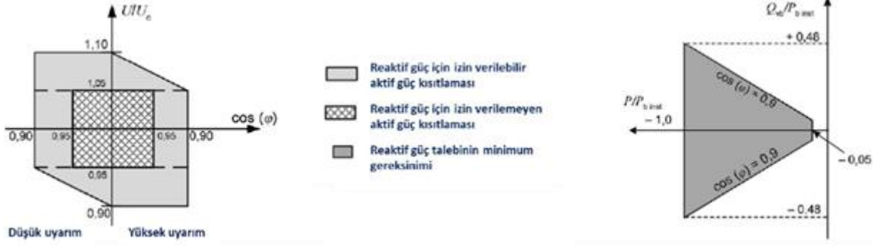
Şekil 1.4 Almanya’da dağıtım şebekesine bağlı PV santrallerin \cos\theta kontrol zorunluluk eğrileri (VDE, 2017)
