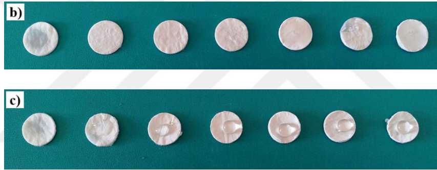
Şekil 6.54. WT/B-xP ayırıcıların a) Temas açısı ölçüm sonuçları, b) Elektrolit damlatma görüntüleri, c) Su damlatma görüntüleri
