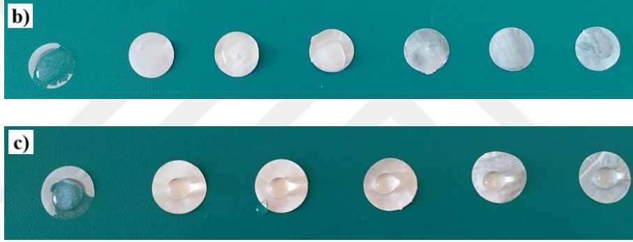
Şekil 6.52. 3501/B-xP ayırıcıların a) Temas açısı ölçüm sonuçları, b) Elektrolit damlatma görüntüleri, c) Su damlatma görüntüleri
