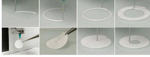
Şekil 4.8. 3D yazıcı ile ayırıcının üretim aşamalarını ait görüntüler [181]
