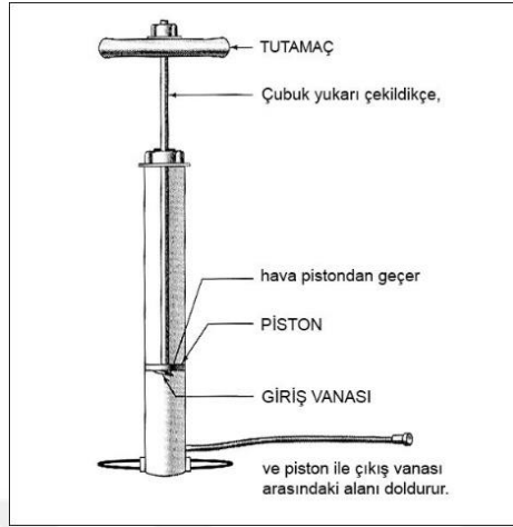
Resim 2.13. Yukarıda bahsi geçen bisiklet pompası örneğinin çalışma prensibini açıklayan deneyde kullanılan görsel
