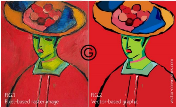
Resim 2.16. Bir görüntünün piksel tabanlı ve vektör tabanlı iki farklı versiyonu
