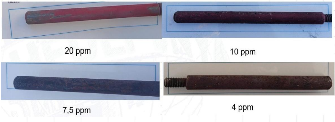
Şekil 5.20 A ve B kuyusunun bağlı olduğu enerji santralinin re-enjeksiyon hattında takılı olan kuponun farklı dozaj miktarlarında yapılan kontrol görselleri.
