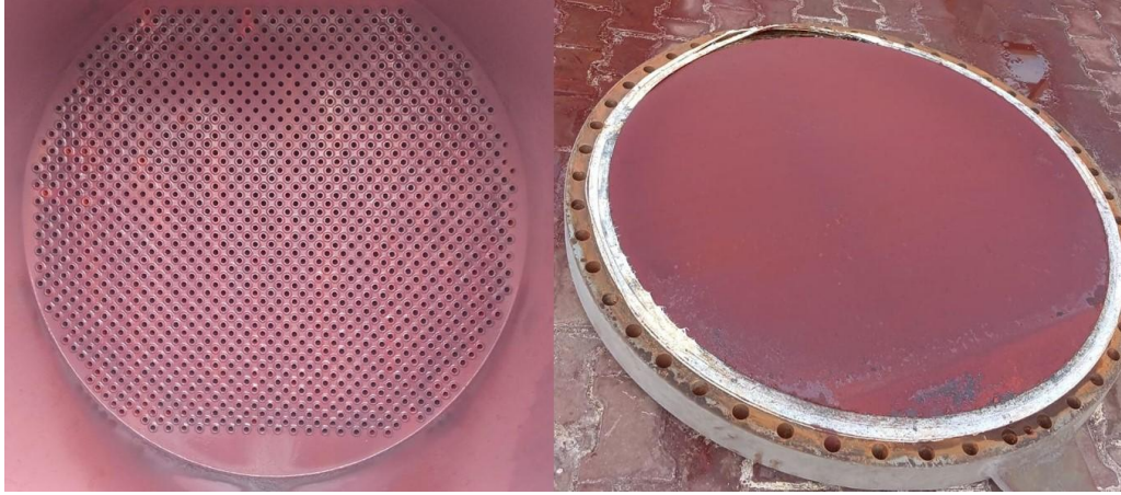
Şekil 4.9 Germencik ilçesinde bulunan özel bir jeotermal enerji santralinin düşük basınç ısı eşanjöründe kabuklaşan stibnit minerali.
