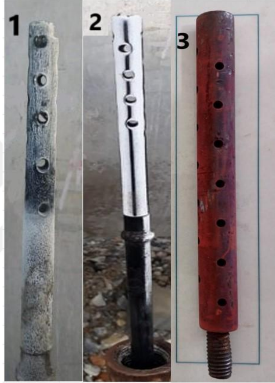
Şekil 5.6 C kuyusundaki separatör sonrası üretim hattında takılı olan kupon [1] A ve B kuyularının bağlı olduğu santralin giriş hattında takılı olan kupon [2] E ve F kuyularının bağlı olduğu santralin re-enjeksiyon çıkış hattında takılı olan kupon [3]
