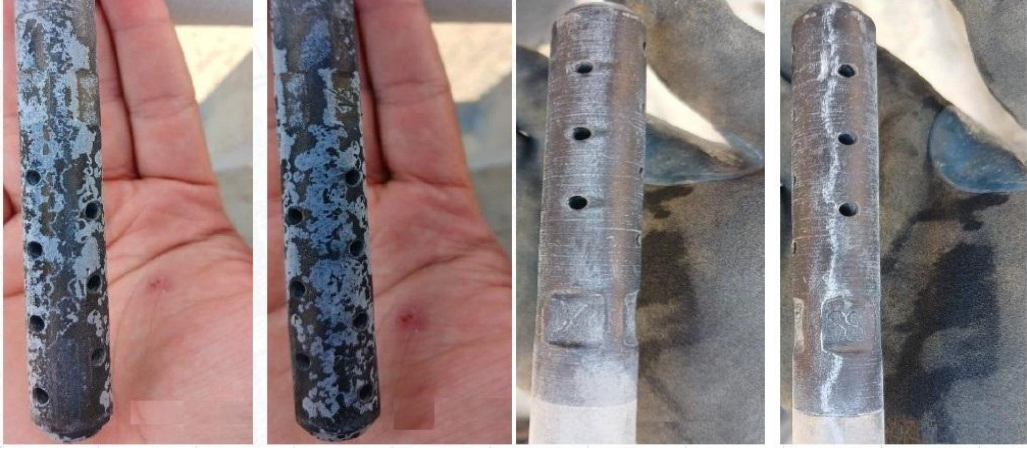
Şekil 5.10 İnh.1 inhibitörünün 15 günlük 14 ppm dozajdaki kupon görseli.
