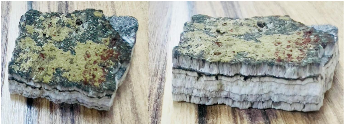
Şekil 4.8 Germencik bölgesinde enerji santrali yüzey boru hattından alınan kabuk numunesi.
