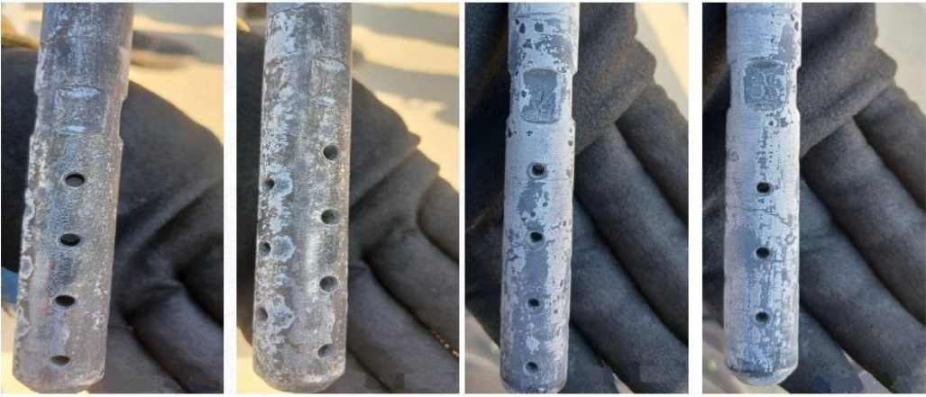
Şekil 5.11 İnh.1 inhibitörünün 15 günlük 7 ppm dozajdaki kupon görseli.
