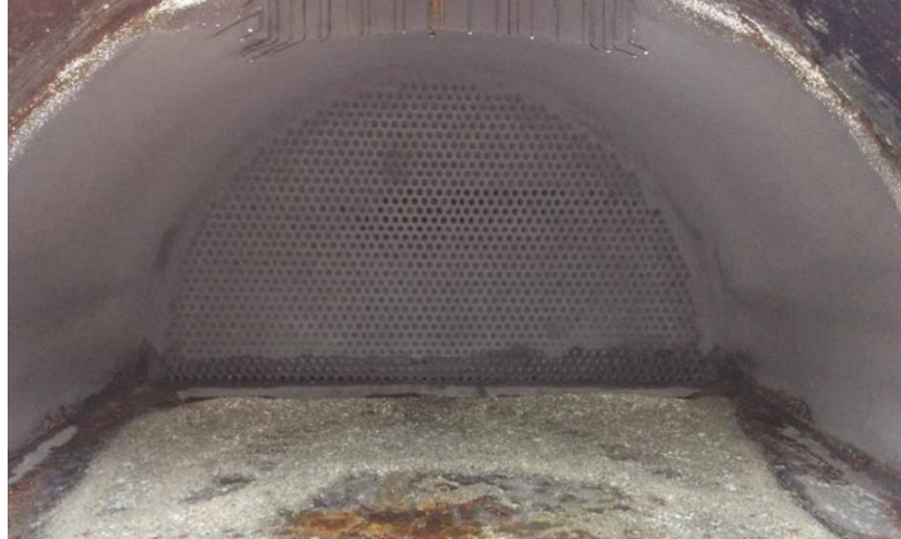
Őekil 4.2 ift evrimli jeotermal enerji santrali dūřük basın ısı eřanjörü silisyum kabuklařması
