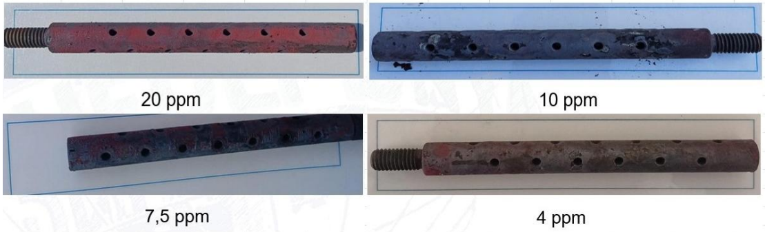
Şekil 5.18 A ve B kuyusunun bağlı olduğu enerji santralının düşük basınçlı ısı değişiricinin çıkış boru hattında takılı olan kuponun farklı dozaj miktarlarındaki kontrol görselleri.
