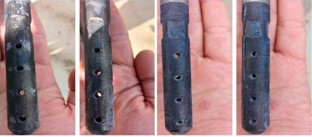
Şekil 5.10 İnh.1 inhibitörünün 15 günlük 14 ppm dozajdaki kupon görseli.
