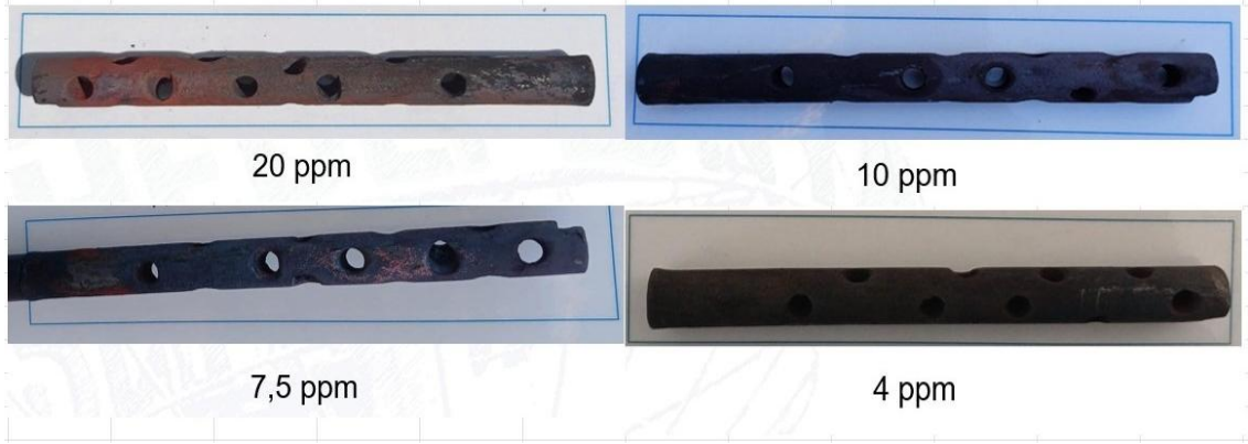
Şekil 5.19 A ve B kuyusunun bağlı olduğu enerji santralinin düşük basınçlı ön ısıtıcı grubunun çıkış boru hattında takılı olan kuponun farklı dozaj miktarlarındaki kontrol görselleri.
