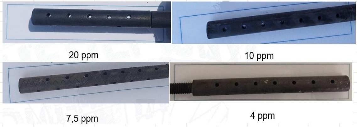
Şekil 5.15 A ve B kuyusunun bağlı olduğu enerji santralinde jeotermal suyun santrale alındığı boru hattında takılı olan kuponun farklı dozaj miktarlarında ve 30 gün sonunda yapılan kontrol görselleri.
