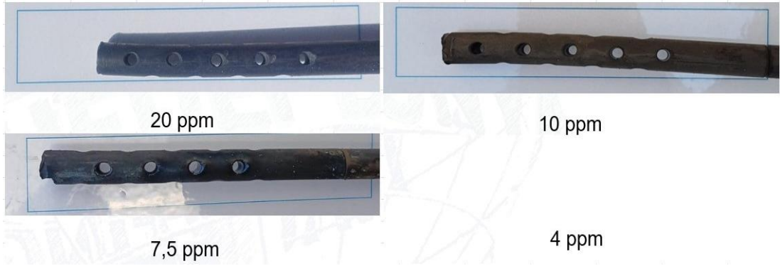
Şekil 5.16 A ve B kuyusunun bağlı olduğu enerji santralinin yüksek basınçlı ısı değiştirici boru hattında takılı olan kuponun farklı dozaj miktarlarındaki kontrol görselleri. (4 ppm dozajı sonunda yaşanan vana arızası nedeniyle kupon sökülememiştir.)
