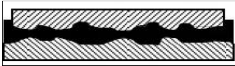
Şekil 7. Sıvı sürtünme şematığı (Erdem, 2017)
