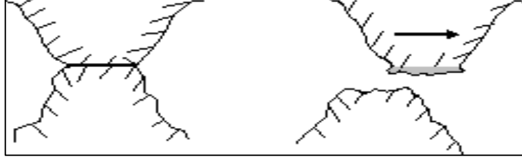
Şekil 10. Adhezif aşınmanın meydana gelişinin şematik olarak gösterimi (Fischer & Bobzin, 2009)
