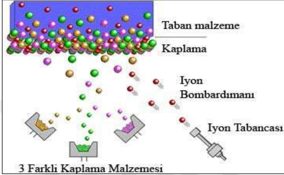
Şekil 26. Elektron bombardmanı ile buharlaştırma tekniği (Oktay, 2007)
