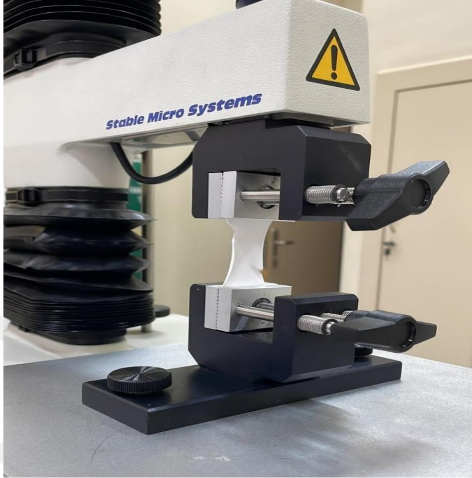
Şekil 3.3. ADF formülasyonları gerilme direnci ölçümünde kullanılan texture analyser .
