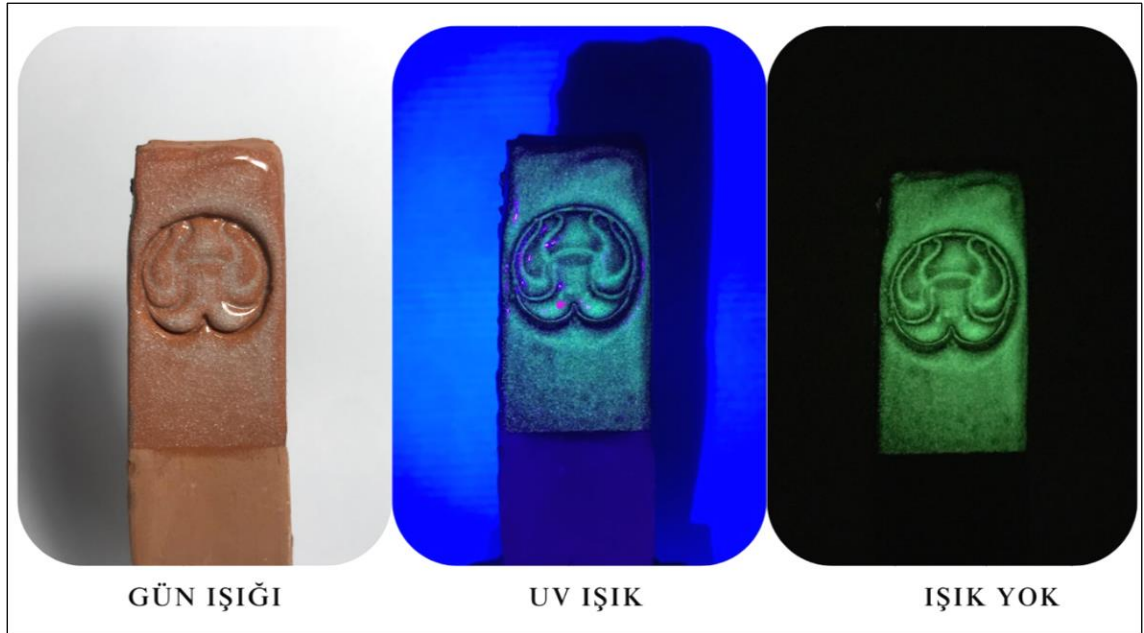
Fotoğraf 66: % 0.5 Kalay Oksit Katkılı Temel Sırın Yüzey Etkisi (Çömlekçi Çamuru - 900°C)
