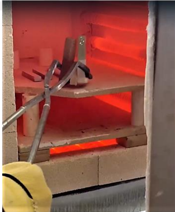
Fotoğraf 24: Denemelerin fırından çıkarılma işlemi.
