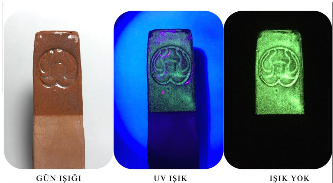
Fotoğraf 59: % 0.5 Mangan Oksit Katkılı Temel Sırın Yüzey Etkisi (Çömlekçi Çamuru -850°C)
