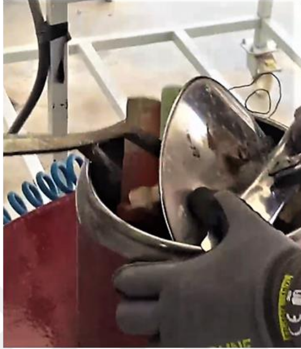
Fotoğraf 25: Denemelerin düdüklü tencere içerisinde vakumlama işlemi.
