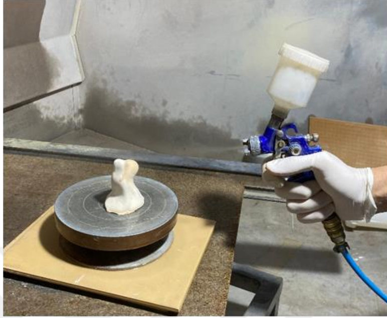
Fotoğraf 22: Pistole ile sır uygulama işlemi.
