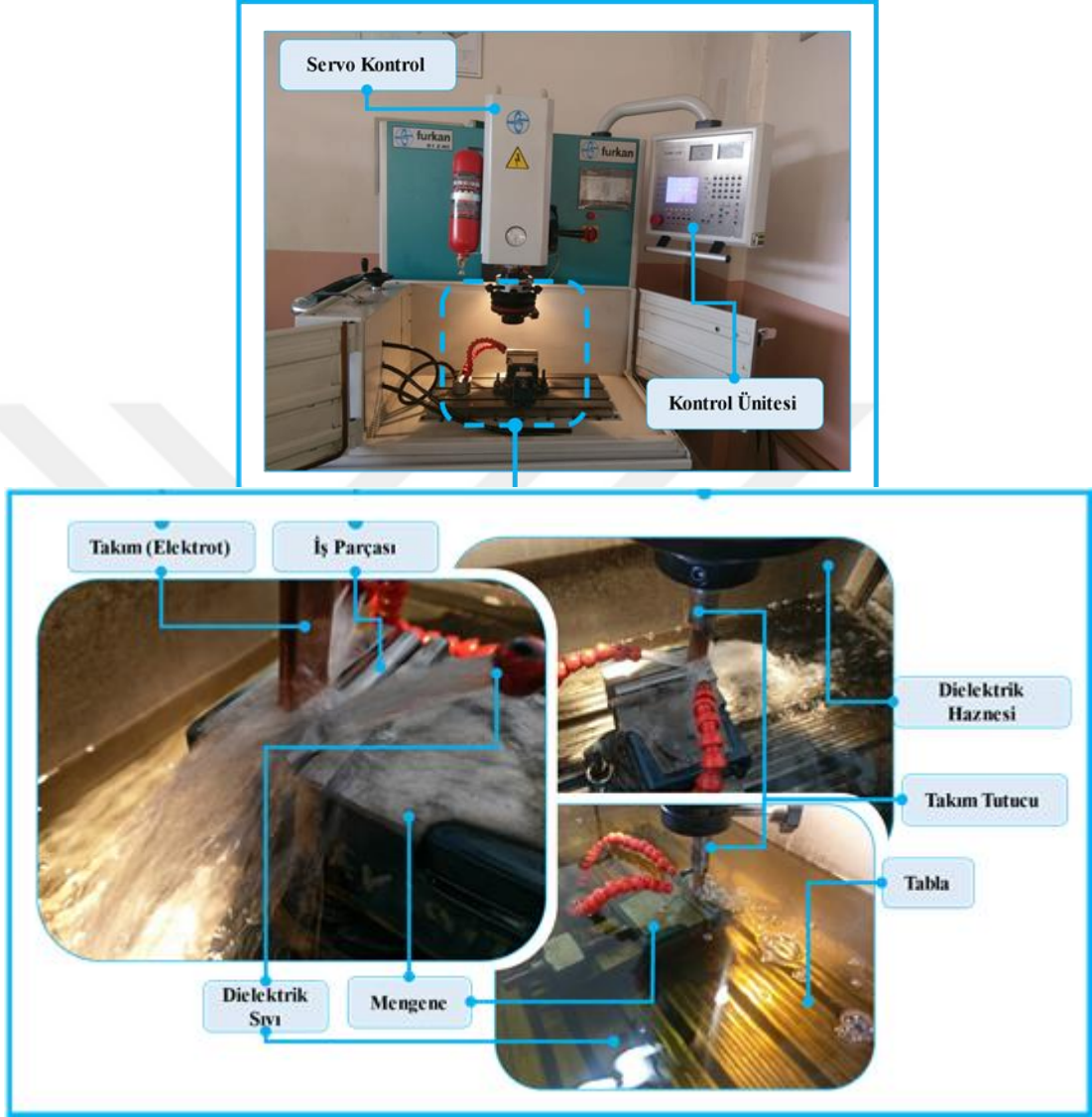
Şekil 4.3. Elektro erozyon ile işleme deney düzeneęi.
