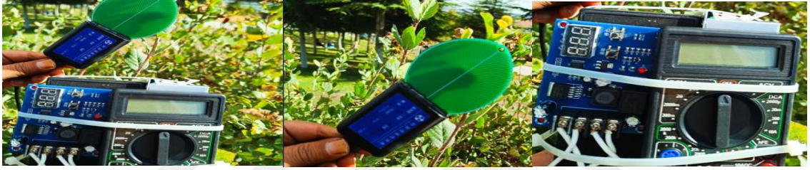
Şekil 3.6. Nemölçer cihazı ve yönlere göre ölçümü
