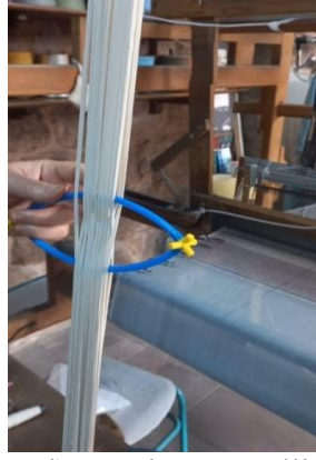
Resim 4.9. Çapraz Çubuklar (Çatal) Hamiyet Gürelli Atölyesi, Nallıhan (Kahraman: 2023).
