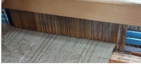
Resim 4.10. Nallıhan da Kullanılan Kamış Tarak, Proje Atölyesi, Nallıhan (Kahraman, 2023).
