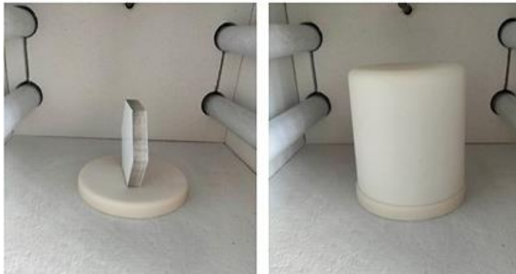
Resim 3.7. Balistik test numunelerinin bağlayıcı uzaklaştırma ve akabinde sinterleme işlemi gerçekleştirilirken fırına koyulma düzeni
