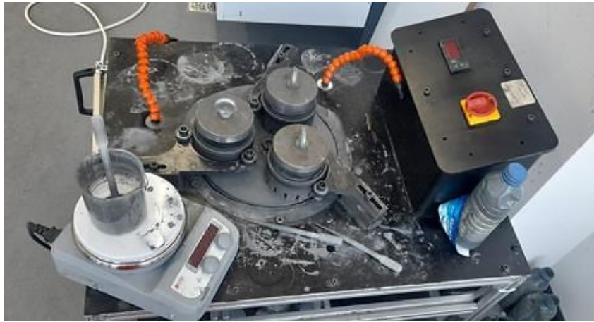
Resim 3.8. Zımparalama işleminde kullanılan lepleme makinası
