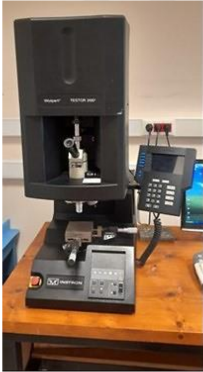
Resim 3.11. Instron marka Wolpert testör 2100 model mikrosertlik cihazı
