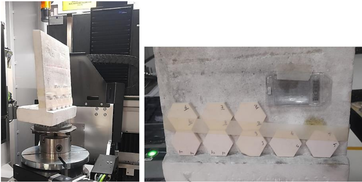
Resim 3.17. Numunelerin XCT görüntüleme cihazına yerleşimi
