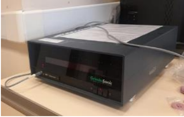
Resim 3.9. Elastisite modülü ölçümlerinde kullanılan Grindosonic® Mk5 test cihazı
