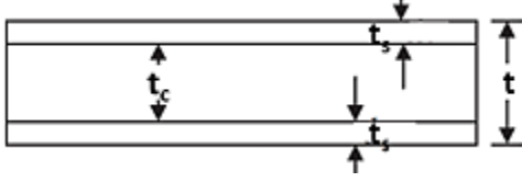
Şekil 2.13. Üç katmanlı sandviç lamine kompozit yapının şematik çizimi
