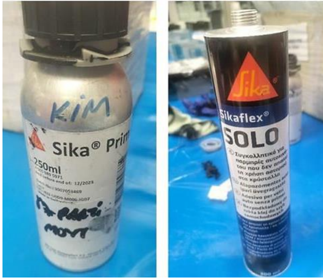
Resim 3.18. Numuneleri polikarbonat desteğe yapıştırmak için kullanılan primer Yapıştırıcı (solda) ve ana yapıştırıcı (sağda)
