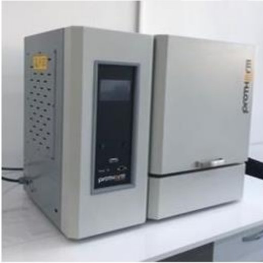
Resim 3.2. Sinterleme işleminde kullanılan kutu fırın
