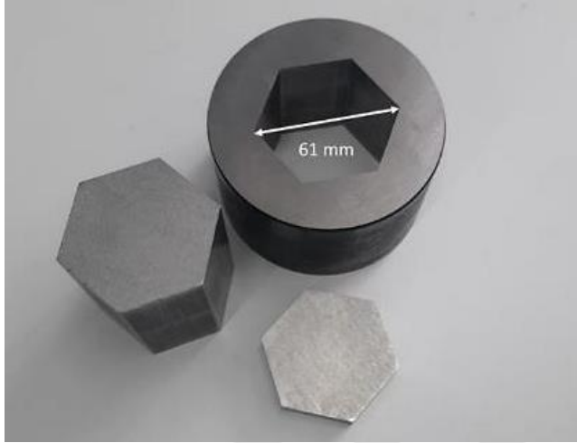
Resim 3.3. DOP testi için numune hazırlamakta kullanılan altıgen çelik kalıp parçaları
