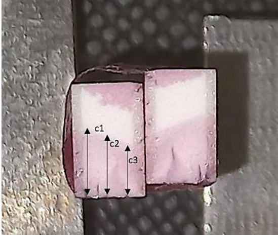
Resim 3.14. Yüzeyde ön çatlak yaratma tokluk testi ile kırılmış ortası \text{Al}_2\text{O}_3 - \%5\text{ZrO}_2 - \%0,8\text{Sm}_2\text{O}_3 olan sandviç numunelerin kırık yüzeylerinin fotoğrafı
