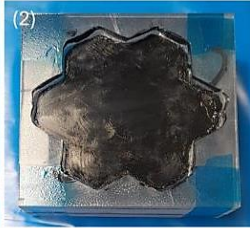
Primer yapıştırıcının uygulanması
