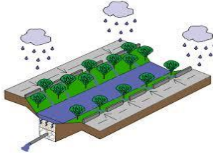
Şekil 6. Yağmur hendekleri genel görünüm (Akyüz 2017)
