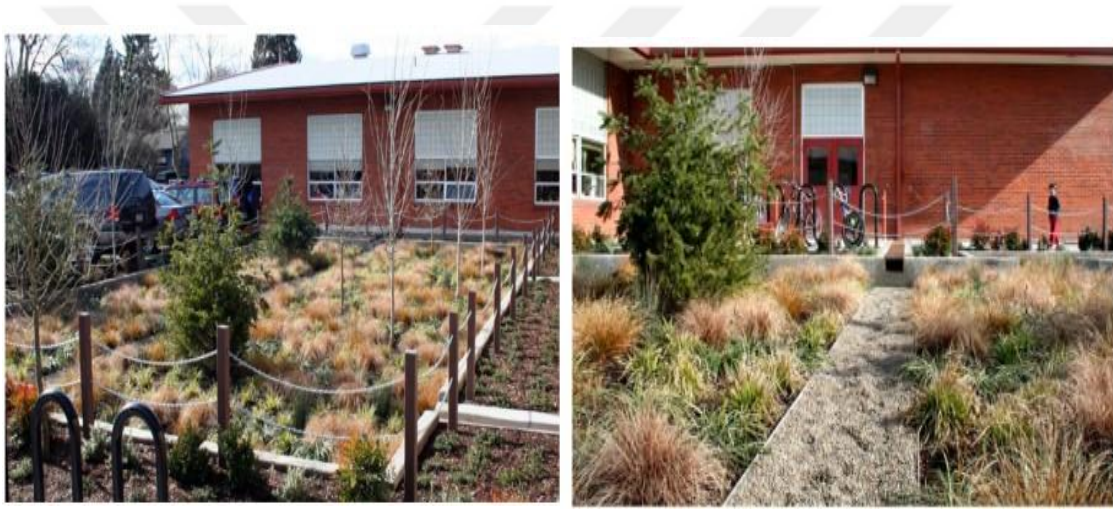
Şekil 16.a) Mount tabor Ortaokulu Yağmur Bahçesi, b) Okulun doğu cephesinde 60 cm genişliğinde çakıl Koridor yapılmıştır(Asla 2016)
