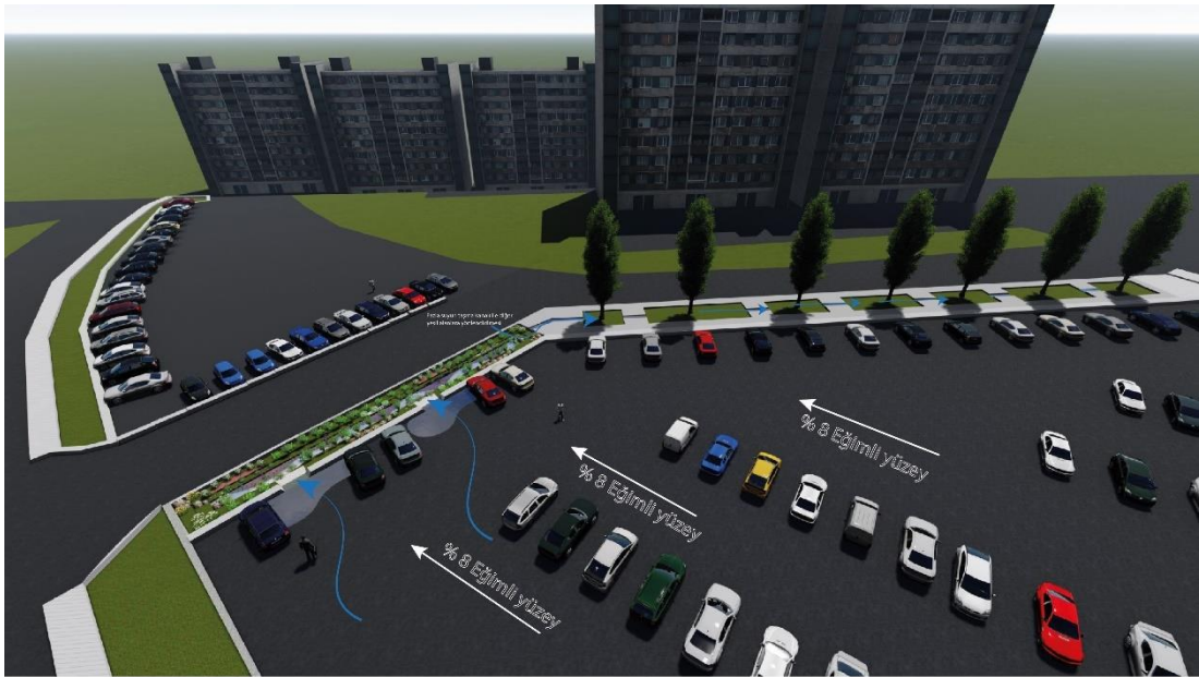
Şekil 51. Yağmur bahçesi taşma suyu ile beslenen alanlar
