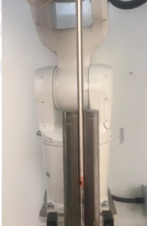
Şekil 2.9. 12.7 mm çaptaki namlu içine girebilecek lazer sistemi. 2
