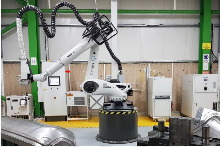
Şekil 4.1. Test numunelerinin hazırlanmasında kullanılan Laserline marka LDF400-100 model lazer sistemi.
