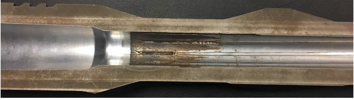
Şekil 2.4. Krom kaplı 20 mm top namlusu kesiti ve hasarlanmış atım yatağı. 1
