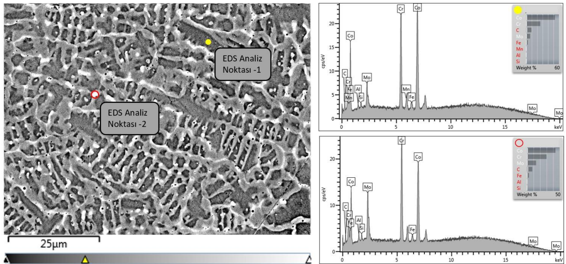
Şekil 5.6. %3 Mo ilaveli Stellite 21 kaplama alaşımının SEM görüntüsü ve fazlara ait EDS analiz Spektrumları.
