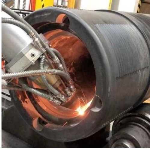
Şekil 2.8. 35 mm top namlusunun kaplama ile tamir işlemi. 1
