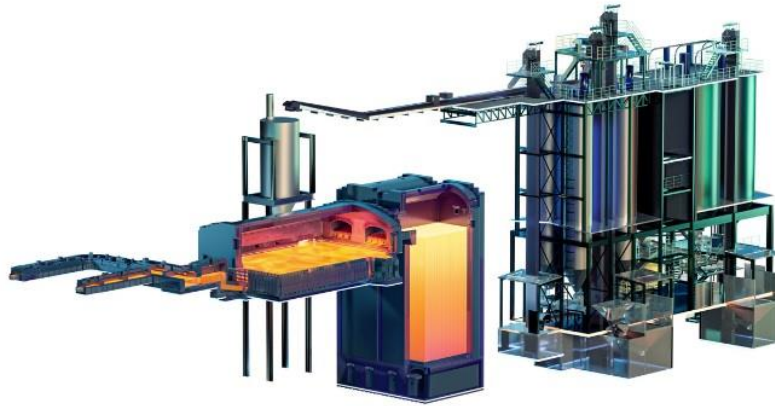
Şekil 1.8 : Cam üretim fırını ve harman dairesi şematik gösterim.
