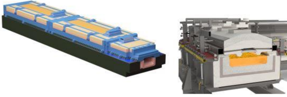
Şekil 1.11: Forehearth 3 boyutlu model görüntüsü ve kesit hali.
