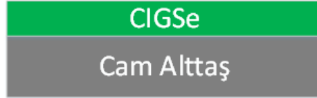
Şekil 3.6 İkinci grup CIGSe filmlerinin üretimi
