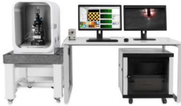
Şekil 3.24 Park Systems XE7 model AKM
