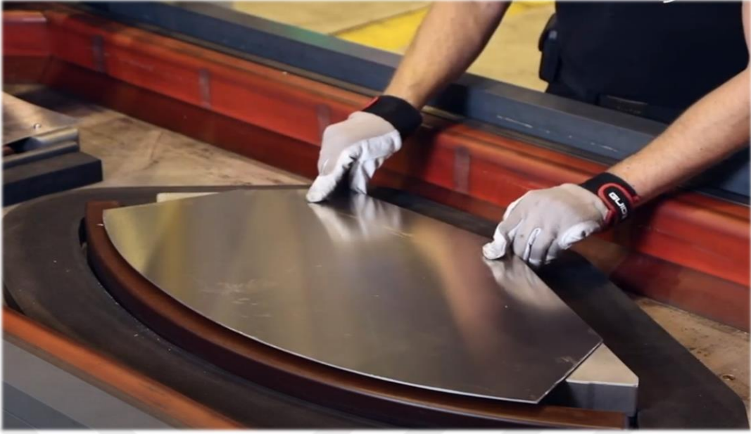
Şekil 2.13. Hidroforming için hazırlanan iş parçası
