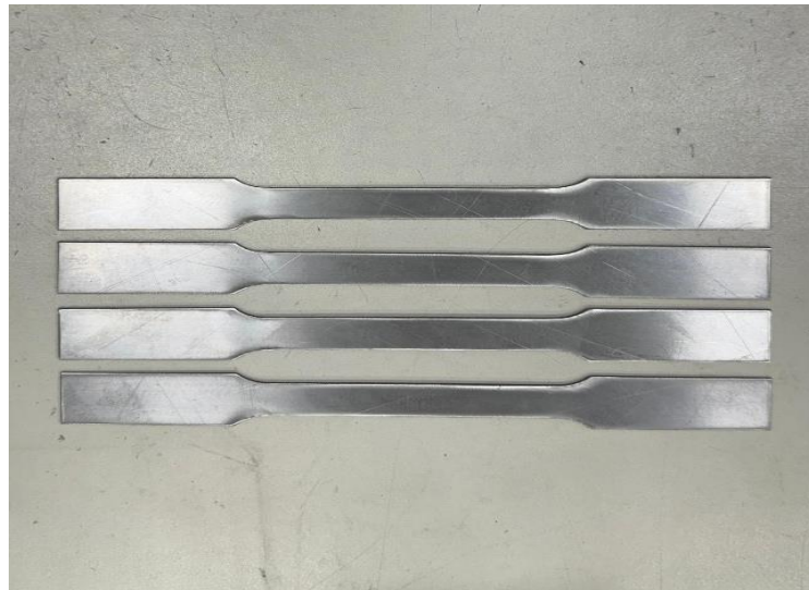
Şekil 3.3. ASTM E8 standardına göre kestirilen AISI-301 çelik numuneler
