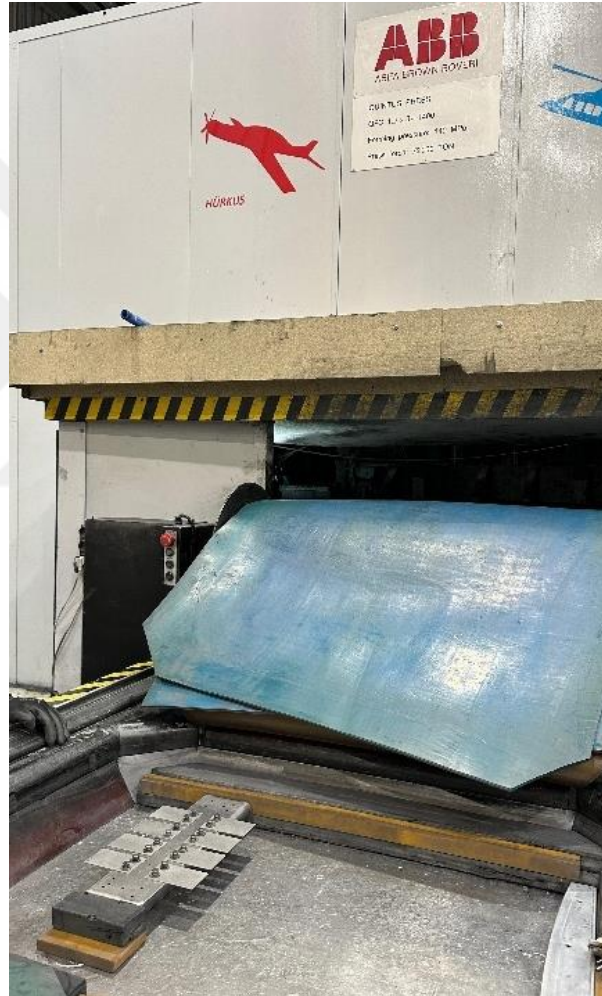
Şekil 3.8. Tezgâh üzerine yerleştirilmiş kalıp ve numuneler
