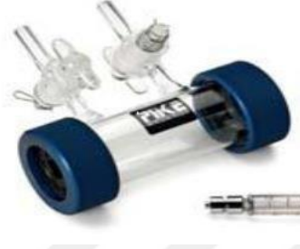
Şekil 1.37: FT- IR gaz ölçüm hücresi.
