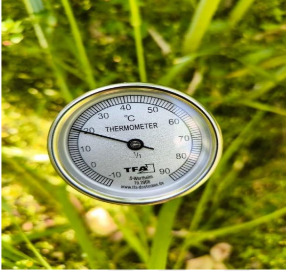
Şekil 27. Toprak sıcaklığının çubuk toprak termometresi ile ölçümü (Orijinal fotoğraf)
