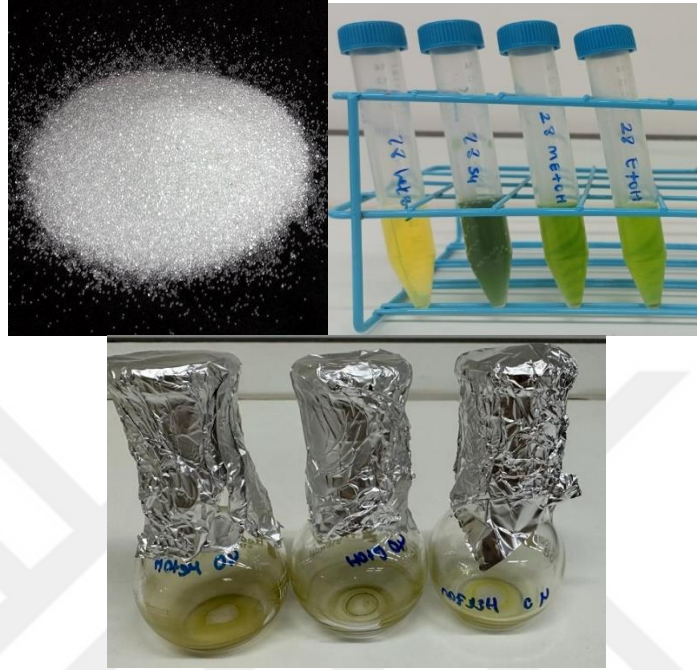
Şekil 0.11 : Cam boncuklar ile ekstraksiyon.
