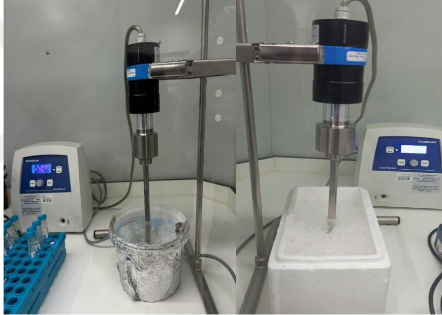
Şekil 0.10 : Sonikasyon işlemi ile ekstraktların hazırlanması ve EPS'lerin homojen hale getirilmesi.
