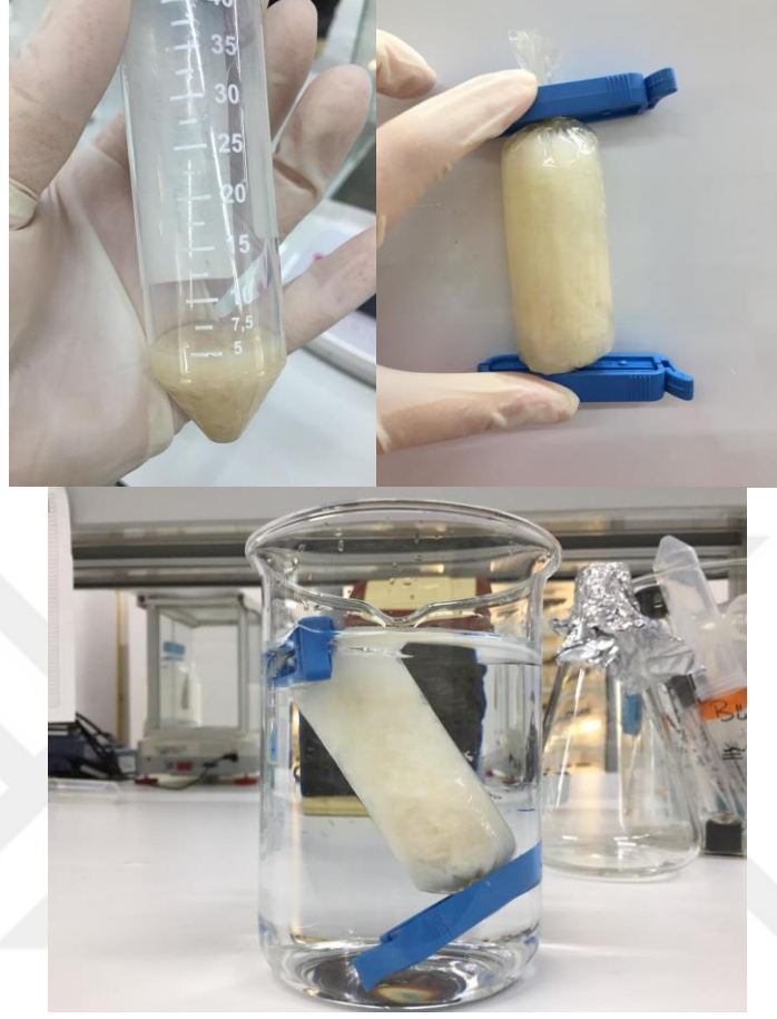
Şekil 0.5 : Diyaliz yöntemi ile tuzların uzaklaştırılması.
