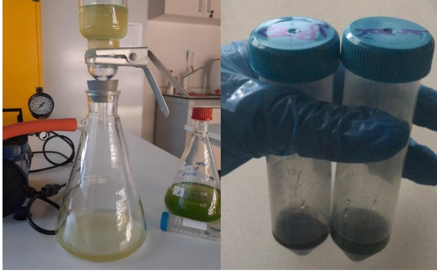
Şekil 0.7 : Hasatta kullanılan filtrasyon sistemi ve santrifüj sonunda elde edilen peletler.
