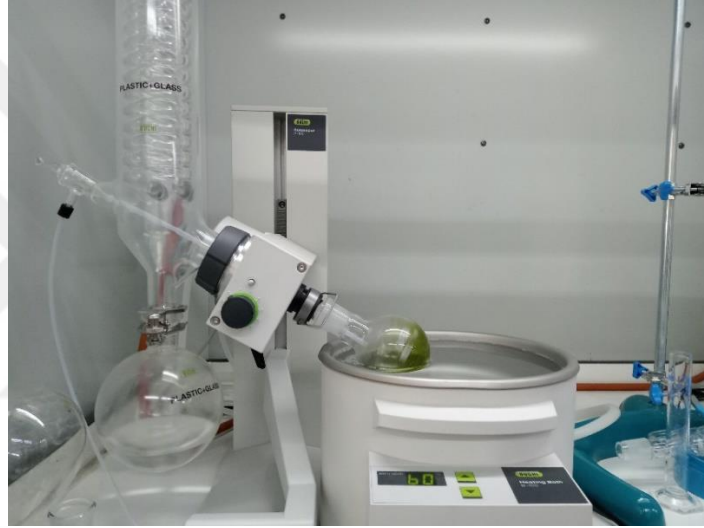
Şekil 0.8 : Soxhlet düzeneği ve rotary-evaporatör.
