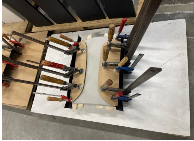
Şekil 3.18. 5S öncesi bombeli dolap kapaklarının işkence yöntemi ile hazırlanması.
