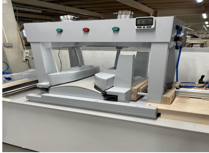
Şekil 3.19. Dolap kapağı oluşturma tertibatı.
