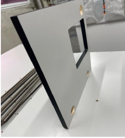
Şekil 3.2. Bir yüzeyi laminat, diğer yüzeyi folyo kaplı levha.
