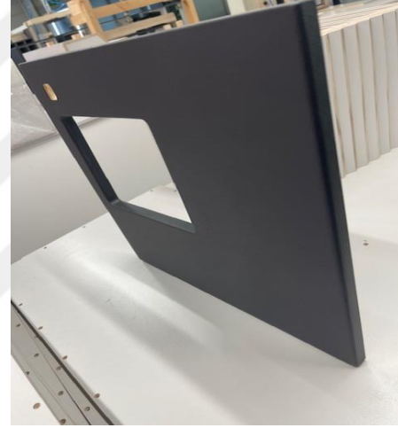
Şekil 3.2. Bir yüzeyi laminat, diğer yüzeyi folyo kaplı levha.
