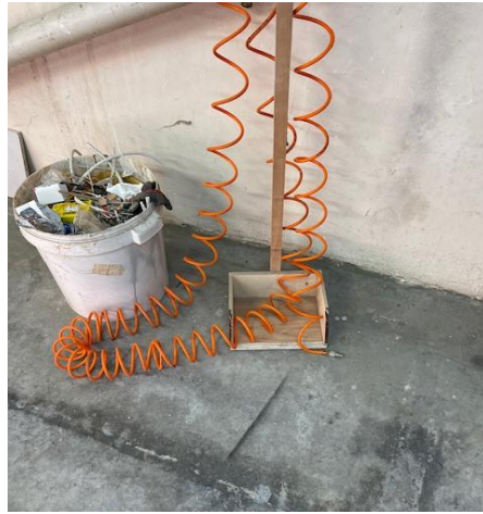
Şekil 3.24. Hava tabancalarının 5S öncesi durumu.
