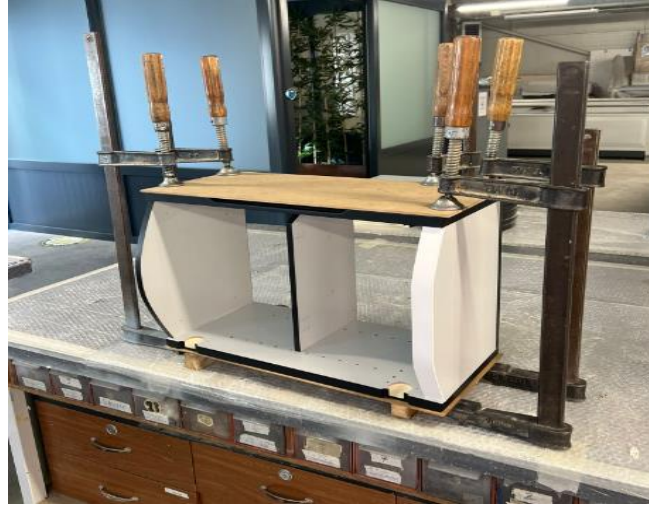
Şekil 3.16. Dolap montaj tertibatı düzenlenmeden önce uygulanan işkence ile montaj işlemi.
