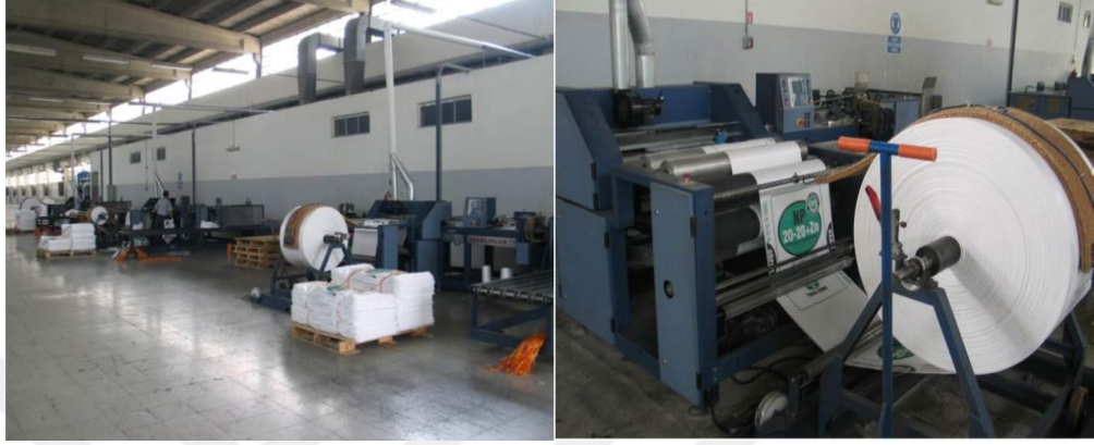
Şekil 1.12 Çekim silindiri ve sıcak kesim
