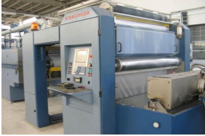
Şekil 1.6 Çekim ve gerdirme ünitesi
