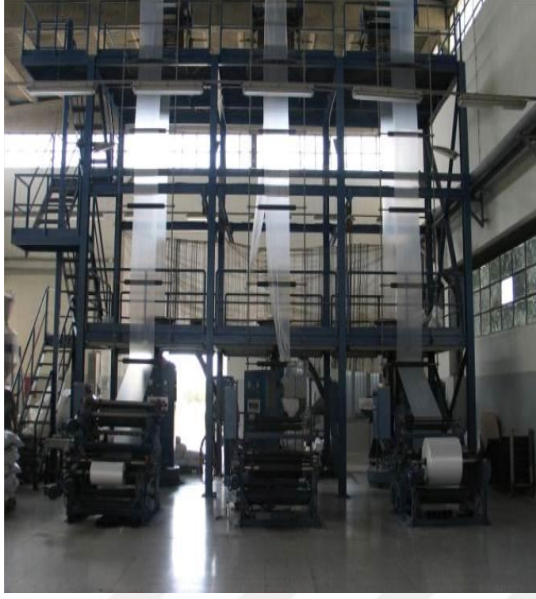
Şekil 1.15 PE film çekim ünitesi hattı
