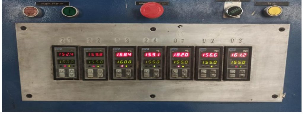
Şekil 4.6 Ölçülen rezistans sıcaklıkları
