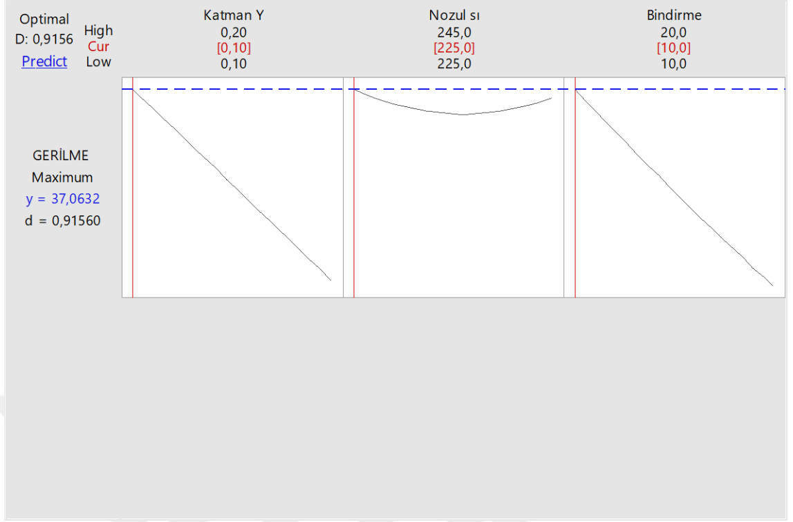
Şekil 4.44: ABS optimum parametre grafiği (somun dış dayanımı).
