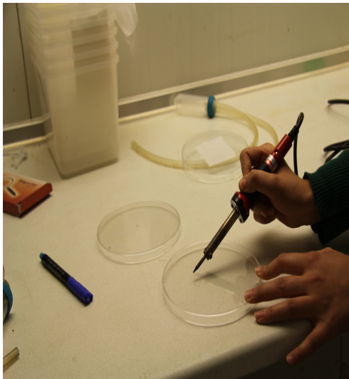
Şekil 3.7 Petri kaplarının delinmesi. Şekil 3.8 Delinmiş petri kabına tül yapıştırılması.
