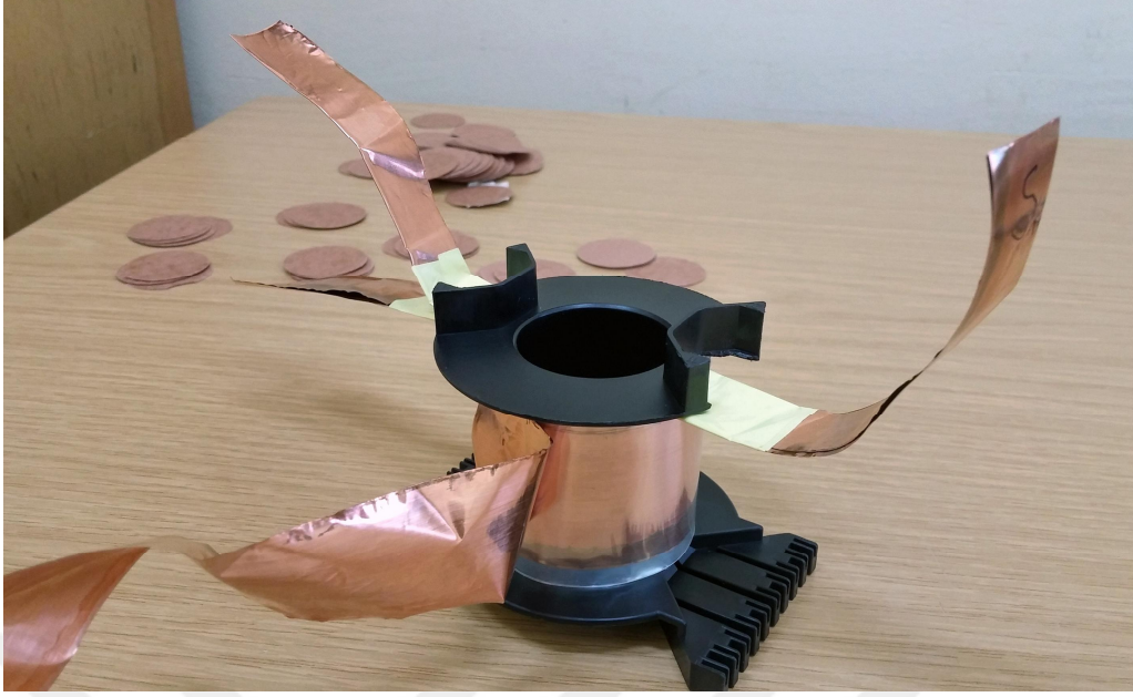
Şekil 3.17. Bakır folyo kullanılarak üretilen trafonun sarım aşaması.
