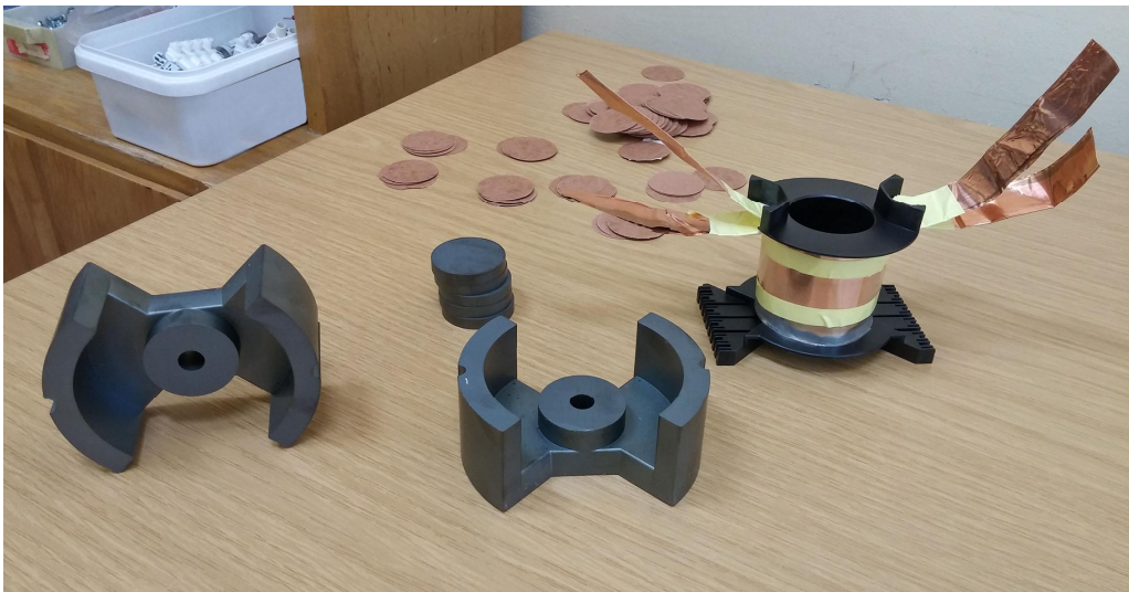
Şekil 3.18. Sarımı tamamlanmış trafo, merkezi 5 dilime ayrılmış çekirdek ve hava boşluğunda kullanılacak malzemeler.
