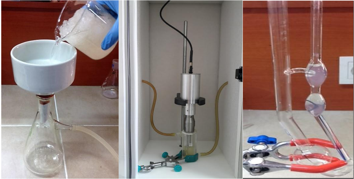
Şekil 4.29: (a) Modifikasyon ön işlemi, (b) Modifikasyon işlemi, (c) Ubbelohde viskozimetresi ile vizkozite ölçümü.
