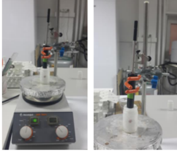
Şekil 3.10 Manuel KFME kullanılarak uçucu bileşenleri adsorpsiyonu
