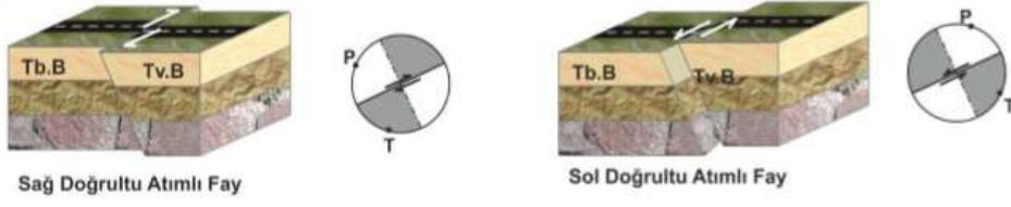
Şekil 2.6 Doğrultu Atımlı (Yatay) Fay (Polat, 2005 dan düzenlenmiştir.)
