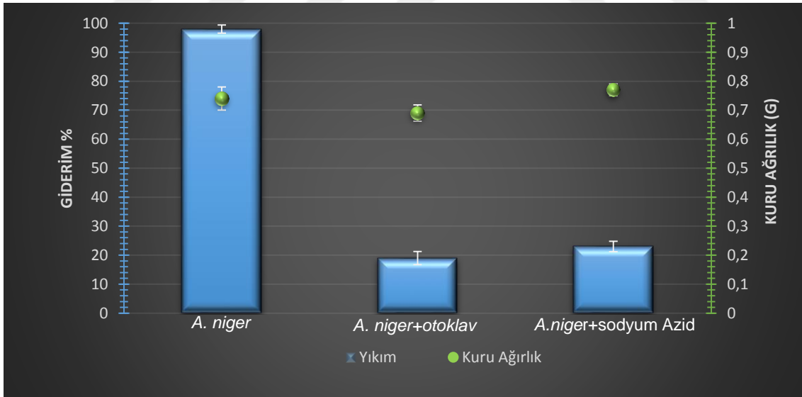
Şekil 4.2. Isı ile öldürülmüş ve kültür ortamına sodyum azid eklenmiş A. niger biyokütleleri ile canlı hücre ortamının naproksen giderimi açısından karşılaştırılması (pH:4.7, 30°C, 150 rpm)
