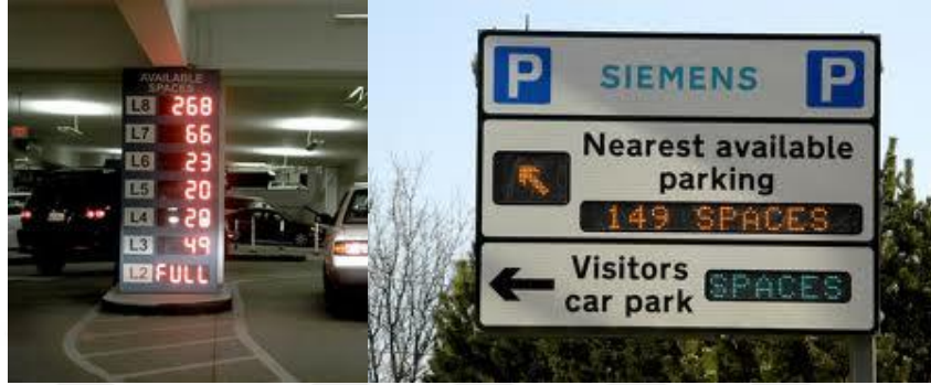
Şekil 4. 10 Sensörlü çevrimiçi otopark işaretleri
