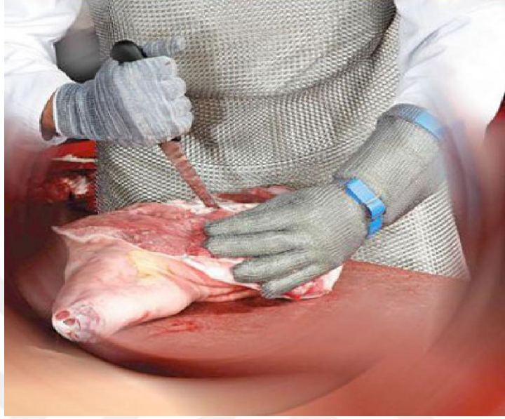
Őekil 2.2 Et kesme ve paralama iřlemlerinde kullanılması gereken kiřisel koruyucu donanımlar (Akkoyun, 2013).
