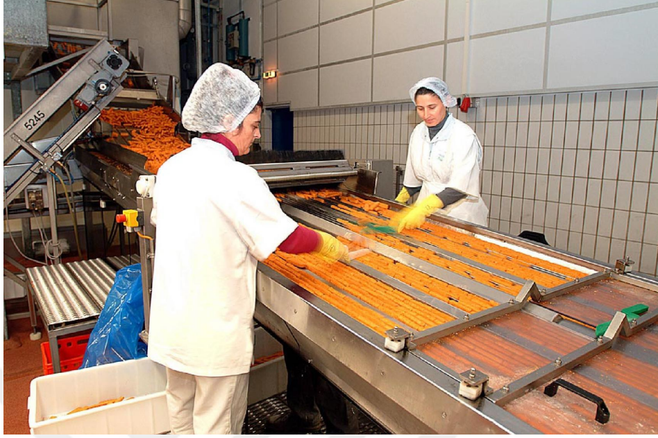
Şekil 2.3 Acil durdurma butonlu ve üzeri kapatılmış konveyör bant (Akkoyun, 2013).
