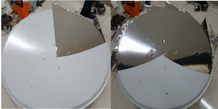
Şekil 4.24. Çanak yansıtıcının folyo ile kaplanması
