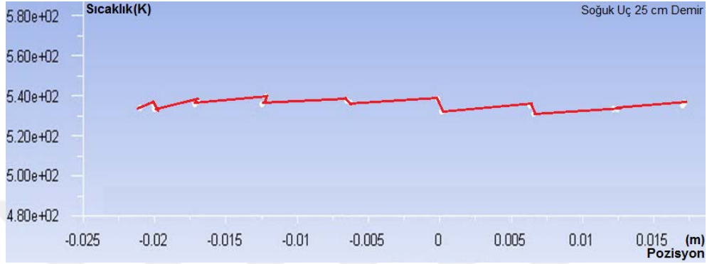
Şekil 4.14. 50 cm uzunluğundaki Demir displacer borusunun sıcaklık değişimi
