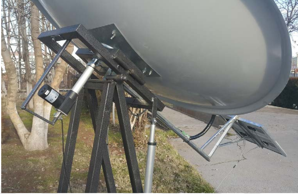
Şekil 3. Doğu-Batı ve Kuzey-Güney yönlü hareket aktüatörleri
