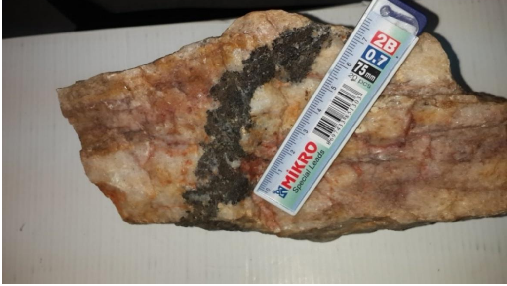
Şekil 4.15. Eroğlu Deresi ve Karaöz Deresi kesişim noktasından alınan turmalin damarlı kuvars (tur: turmalin, Q: kuvars).
