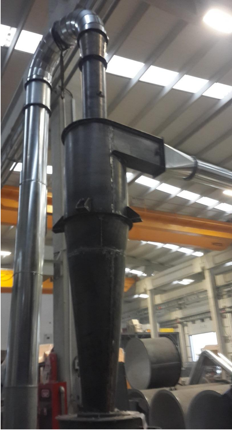
Resim 4.4. Siklon çıkış boru çapı D_e=0,4D olan siklon için deney düzeneği
