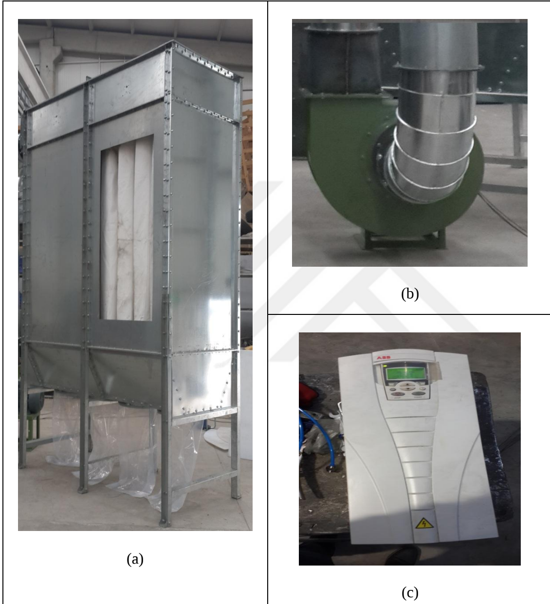
Resim 4.5. Deney ekipmanları: (a) bez filtre, (b) salyangoz fan, (c) hız ayarlayıcısı
