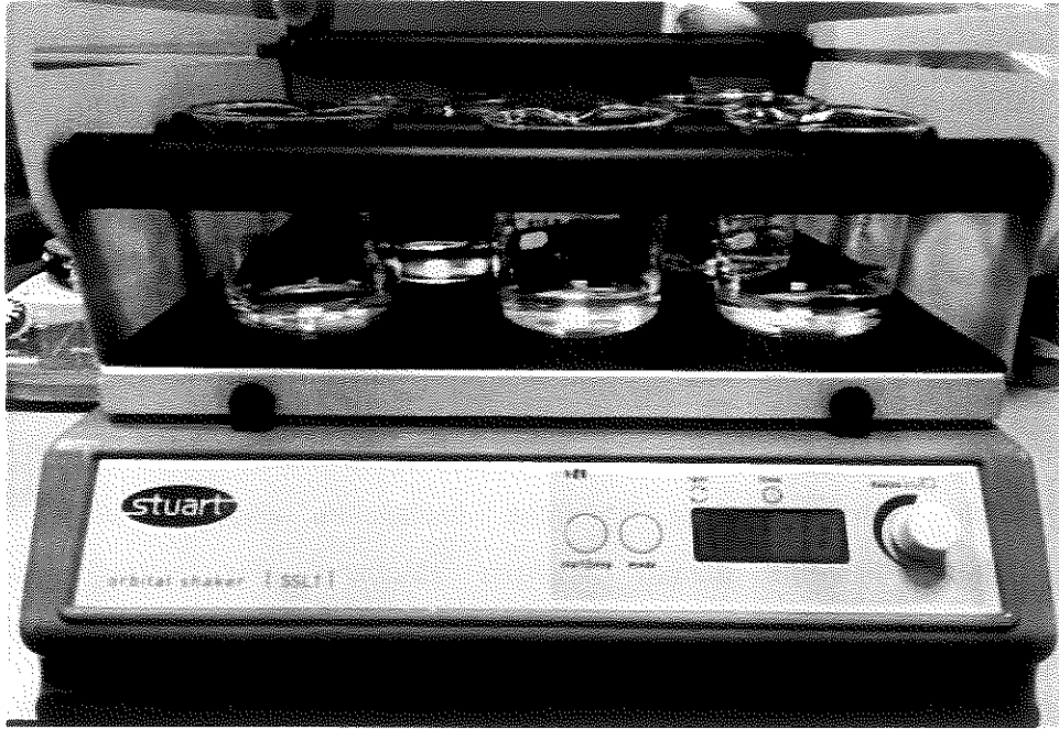
Şekil 2.6: Fitokimyasallar ve fitokimyasal içeren mikrokapsüllerin oksidasyon düzeneği
