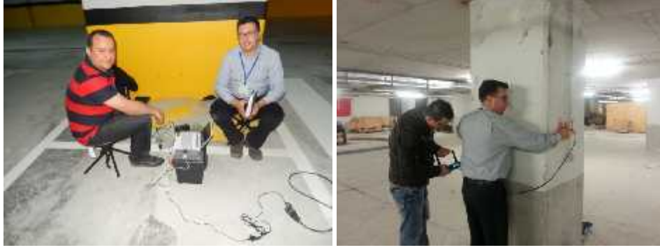
Şekil 6.37. Folkart kuleler bodrum kat mikrotremor ve sismik ölçümleri
