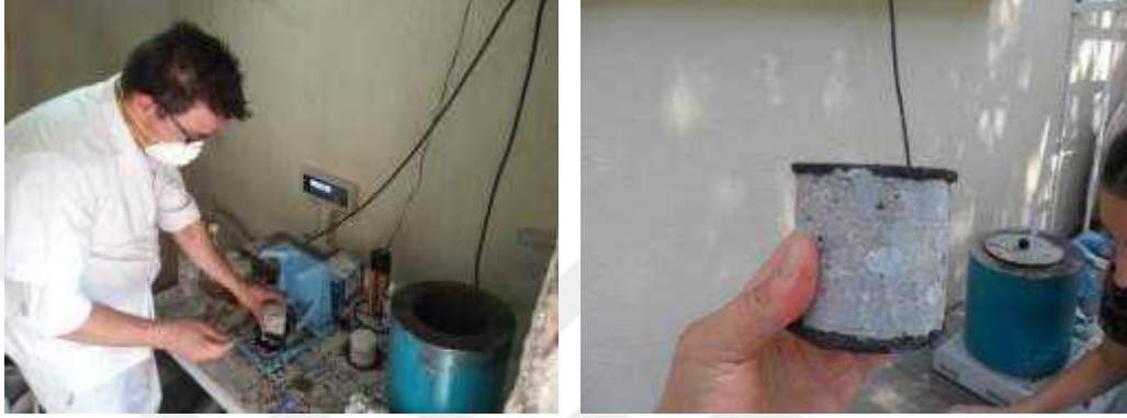
Şekil 4.12. Karot numunelerin başlıklanması işlemi
