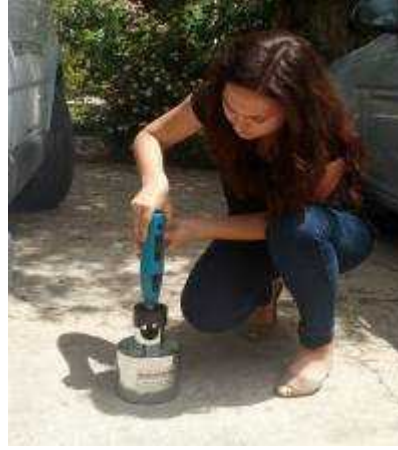
Şekil 4.4. Test çekici örsü ve kalibrasyon işlemi
