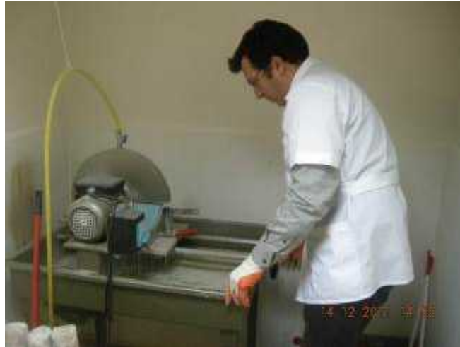
Şekil 4.11. Taş kesme makinesi ile numune düzeltme
