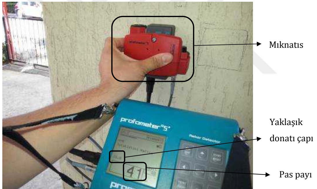
Şekil 5.9. Cihaz üzerinde sonuçların gösterimi
