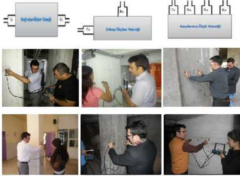
Şekil 5.5. Kolon üzerinden yerinde sismik ultrason yöntemin farklı uygulamaları.
