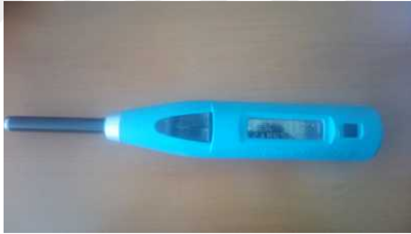
Şekil 4.1. Beton test çekici cihazı (Schmidt Çekici).
