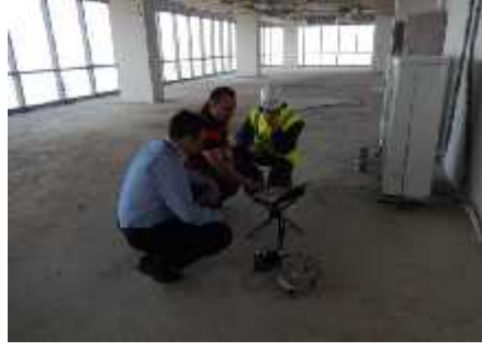
Şekil 6.36. Folkart kulede alınan mikrotremor ölçümü
