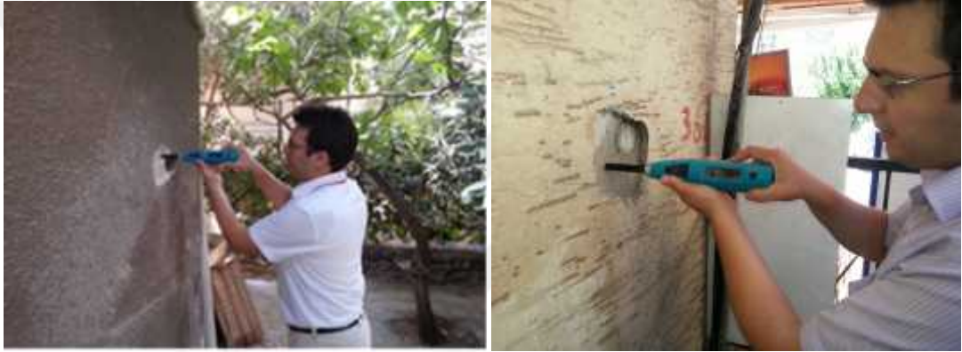
Şekil 4.3. Sahada test çekici çalışması
