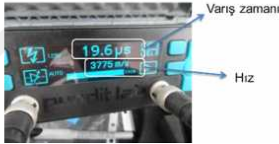
Şekil 5.4. Sismik hızın cihaz üzerinde gösterimi
