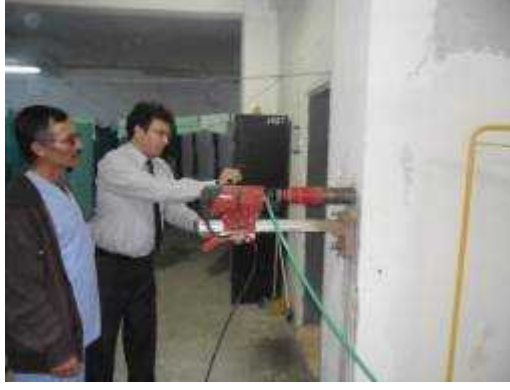
Şekil 4.5. Karot makinesi ile numune alımı
