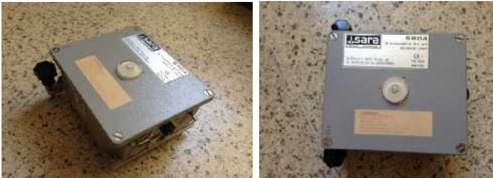
Şekil 5.15. Mikrotremör veri toplama cihazı (Bostaner 2014)
