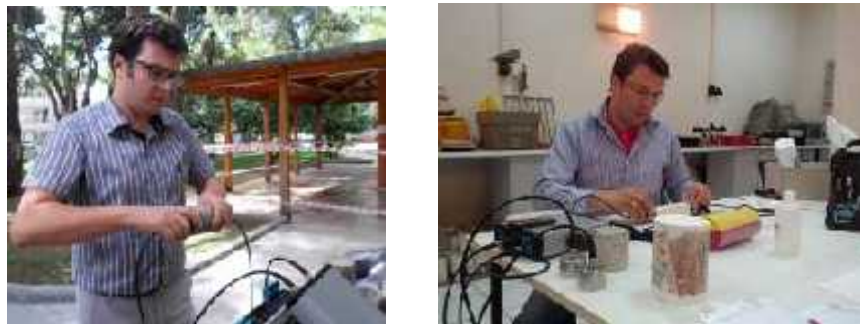
Şekil 5.6. Numuneler üzerinden sismik ultrason yöntemin uygulanması
