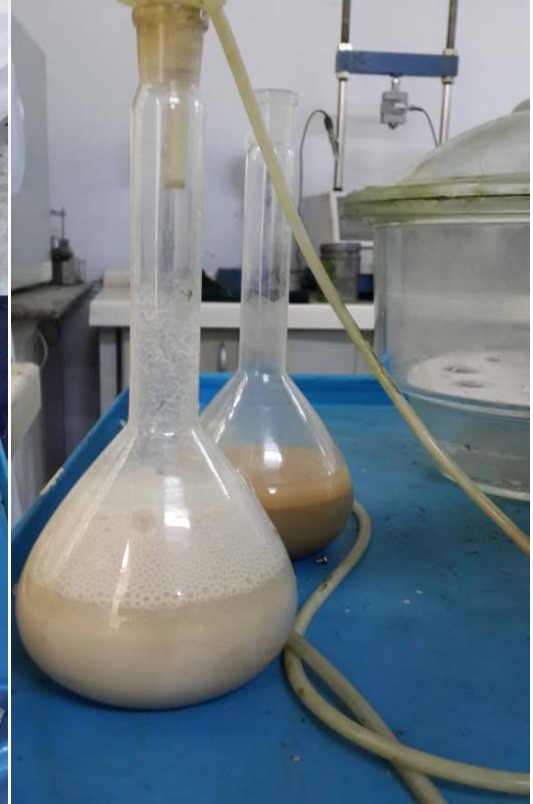
Şekil 4.8. Mineral filler için Zahiri özgül ağırlık deneyi uygulanır.
