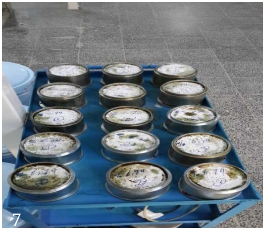
Şekil 4.14. Marshall briket numuneleri hazırlanmasının aşamaları
