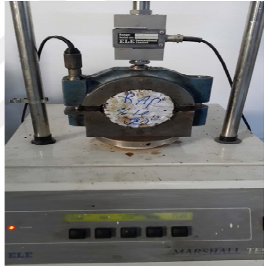
Şekil 4.17. RAP malzemesi kullanılan Marshall deneyi uygulanır.
