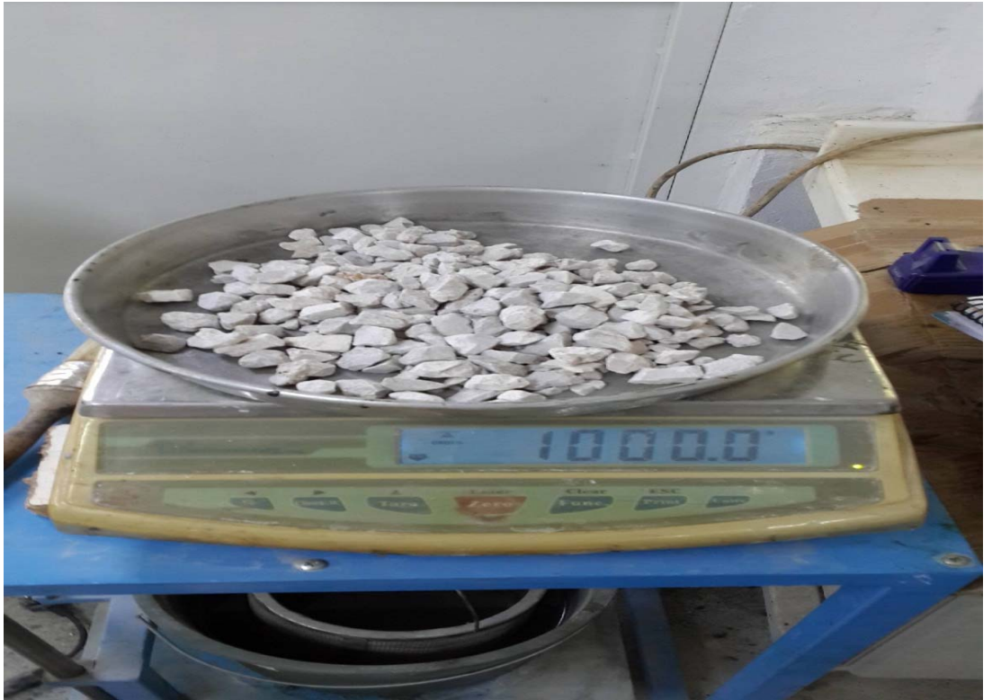
Şekil 4.5. Özgöl ağırlık deneyi için normal iri agregalar tartılır.
