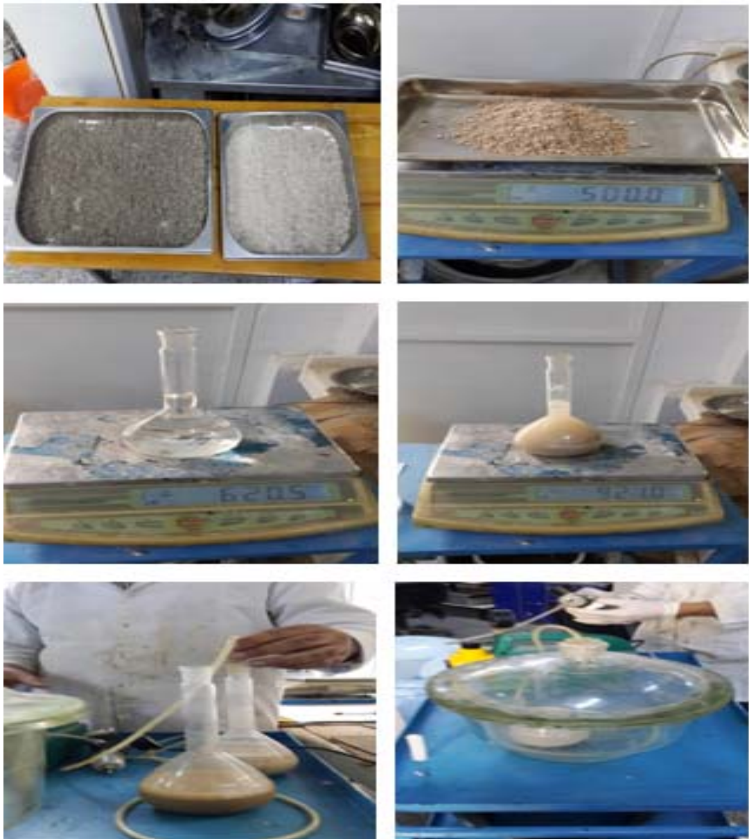
Şekil 4.7. İnce agregâ için özgül ağırlık deneyi uygulanır.
