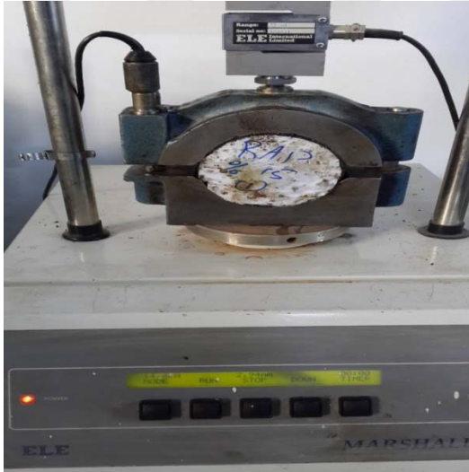
Şekil 4.17. RAP malzemesi kullanılan Marshall deneyi uygulanır.
