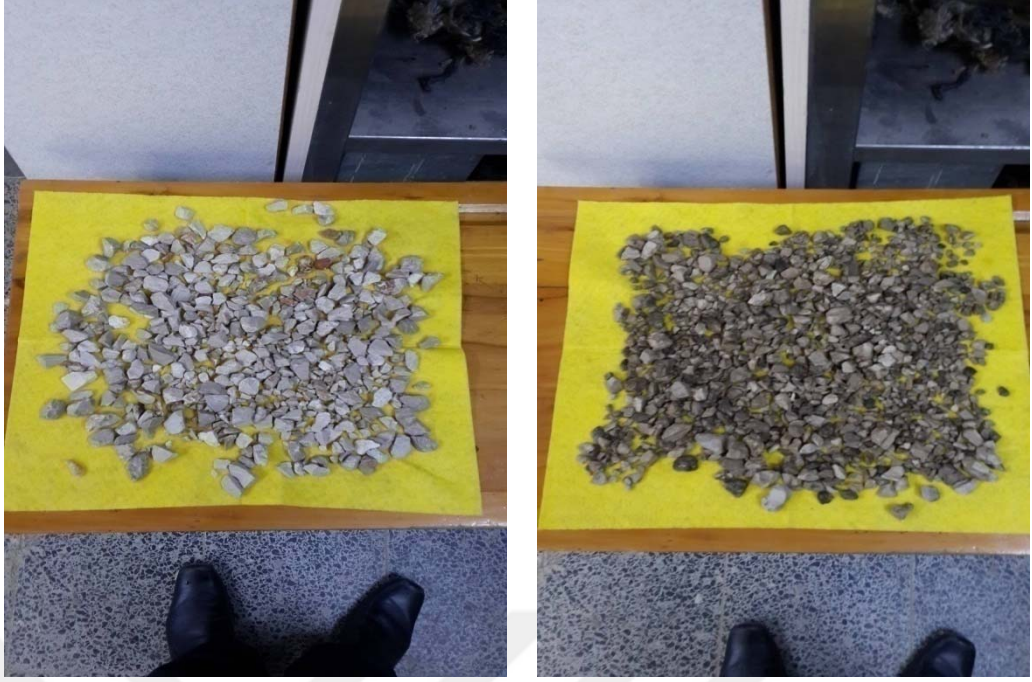
Şekil 4.6. Bez üzerine yayılarak agrega daneleri kurulanır.
