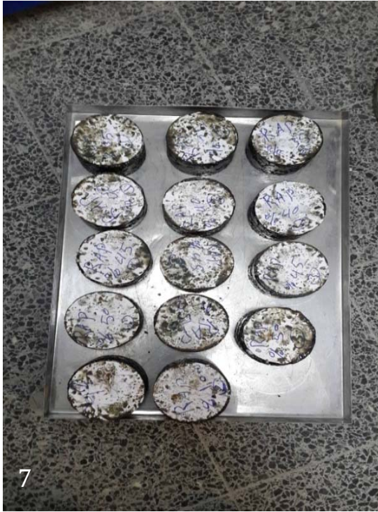
Şekil 4.16. RAP malzemesi kullanılan Marshall briket numuneleri hazırlanmasının hazırlanmasının aşamaları (devam)
