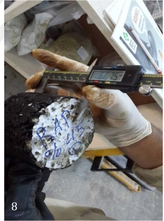
Şekil 4.16. RAP malzemesi kullanılan Marshall briket numuneleri hazırlanmasının hazırlanmasının aşamaları (devam)
