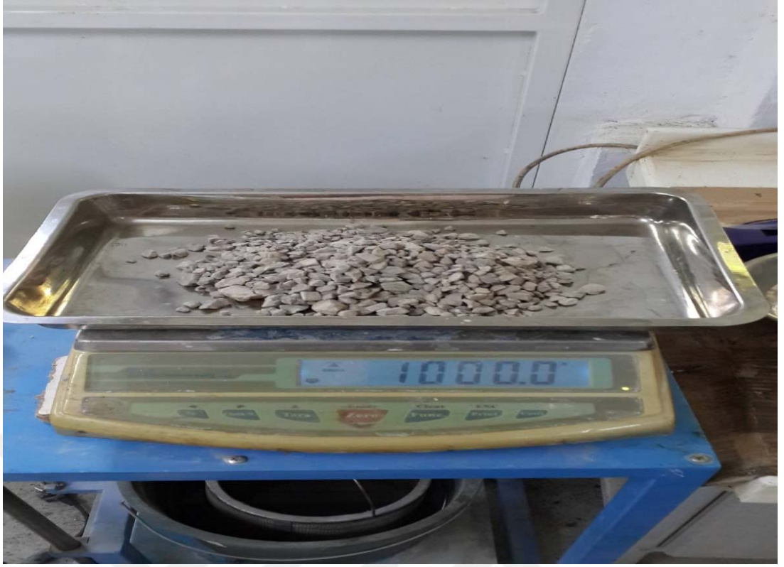
Şekil 4.4. Özgöl ağırlık deneyi için RAP malzemesinin ekstraksiyon kalıntısı iri agregalar tartılır.
