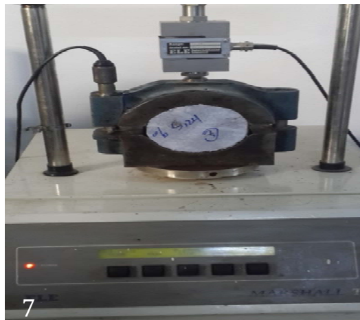
Şekil 4.15. Marshall deneyi uygulanma aşamaları
