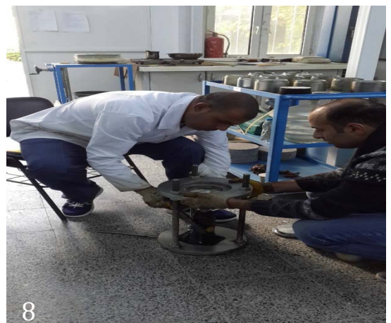
Şekil 4.14. Marshall briket numuneleri hazırlanmasının aşamaları
