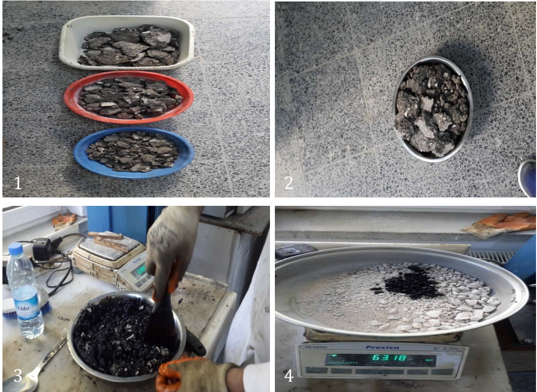
Şekil 4.16. RAP malzemesi kullanılan Marshall briket numuneleri hazırlanmasının aşamaları
