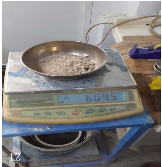
Şekil 4.2. Ekstraksiyon deneyi uygulanma aşamaları (devam)
