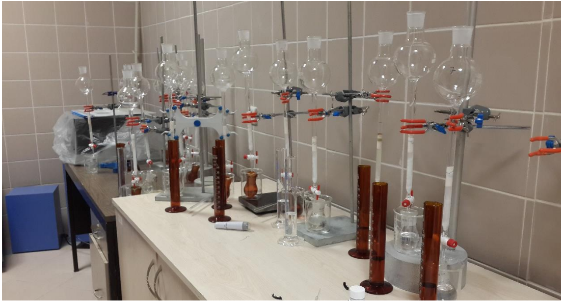
Şekil 3.6. Temizleme (clean-up) kolonlarının genel görünüşü
