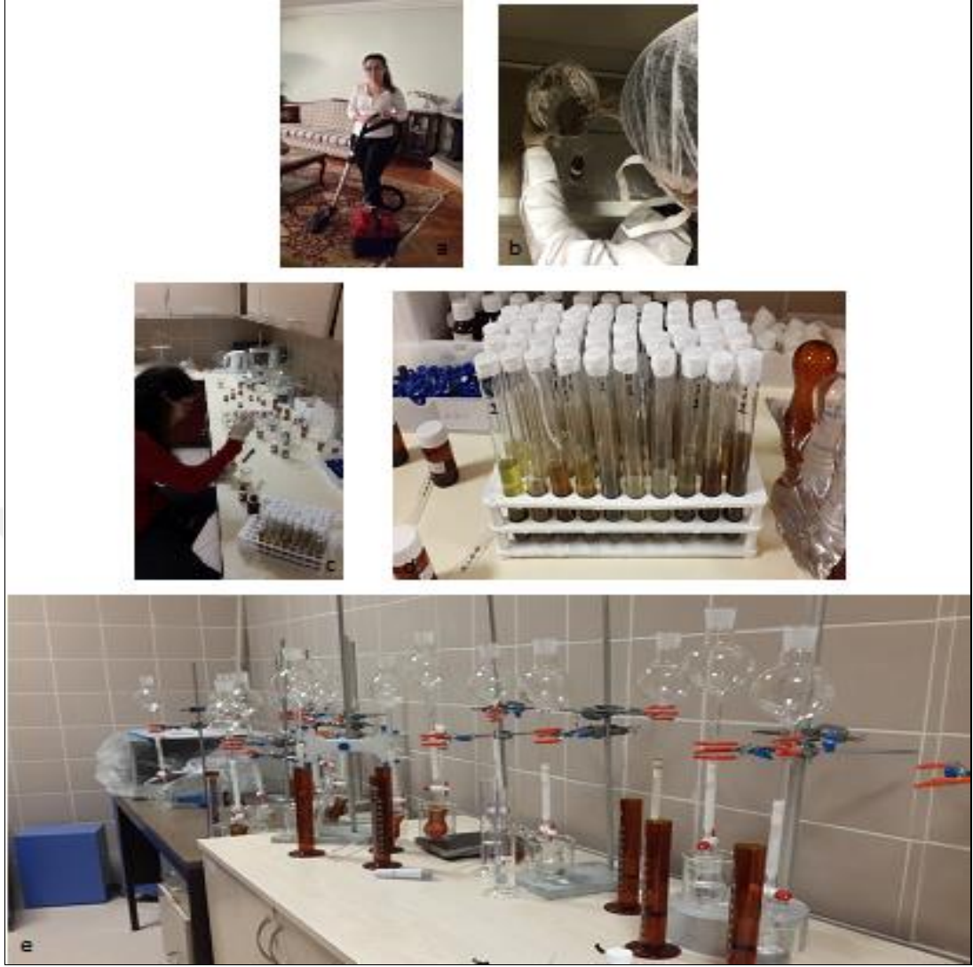
Şekil 3.4. Yapılan çalışmaya ait resimler ( a- çalışma grubu, b- laboratuvar ortamında toz ayıklanması, c- ekstraksiyon işlemi, d- ekstraksiyon edilmiş numuneler, e- kolonlar)
